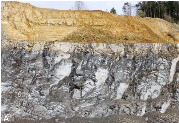
Abb.2.2-35: Abbau im Steinbruch Schelklingen-Vohenbronnen (RG 7624-5). A) In Teilen des Steinbruchs werden die tonigen Kalksteine (bräunlich-beige, oben) und Mergelsteine (dunkel-bläulichgrau) der Zementmergel-Formation (Oberjura) gewonnen. B) Gewinnung von gebankten Kalksteinen des Oberjuras.
