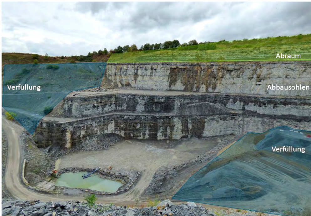
Abb.1.3-1: Im Steinbruch Bretzfeld- Weißleinsburg bei Bretzfeld (RG 6722-4) wird in mehreren Abbausohlen (sog. Bermen) Kalkstein ab- gebaut. Der Abraum hat i. d. R. eine eigene Abraumsohle. Teil- bereiche werden zur Rekultivierung bereits wieder verfüllt.
