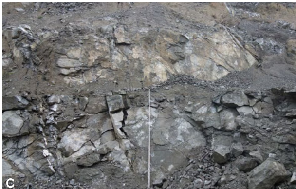
Abb.2.2-32: Gewinnung von Natursteinen aus dem Grundgebirge in Baden-Württemberg. A) Abbauwand im Steinbruch Ottenhöfen im Schwarzwald (RG 7415-3), Gewinnung von Grünberg-Quarzporphyr und Seebach-Granit. B) Rötlich-grauer, grobkörniger, gleichkörnig ausgebildeter Triberg-Granit aus dem Steinbruch Schramberg (RG 7716-001). C) Abbauwand im Phonolith-Steinbruch bei Bötzingen (RG 7912-1, Länge des Maßstabs 5 m). D) Migmatit mit Paragneisrelikten als Beispiel für Metamorphite, Todtnauberg.
