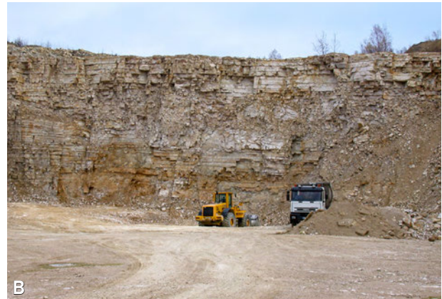
Abb.2.2-35: Abbau im Steinbruch Schelklingen-Vohenbronnen (RG 7624-5). A) In Teilen des Steinbruchs werden die tonigen Kalksteine (bräunlich-beige, oben) und Mergelsteine (dunkel-bläulichgrau) der Zementmergel-Formation (Oberjura) gewonnen. B) Gewinnung von gebankten Kalksteinen des Oberjuras.
