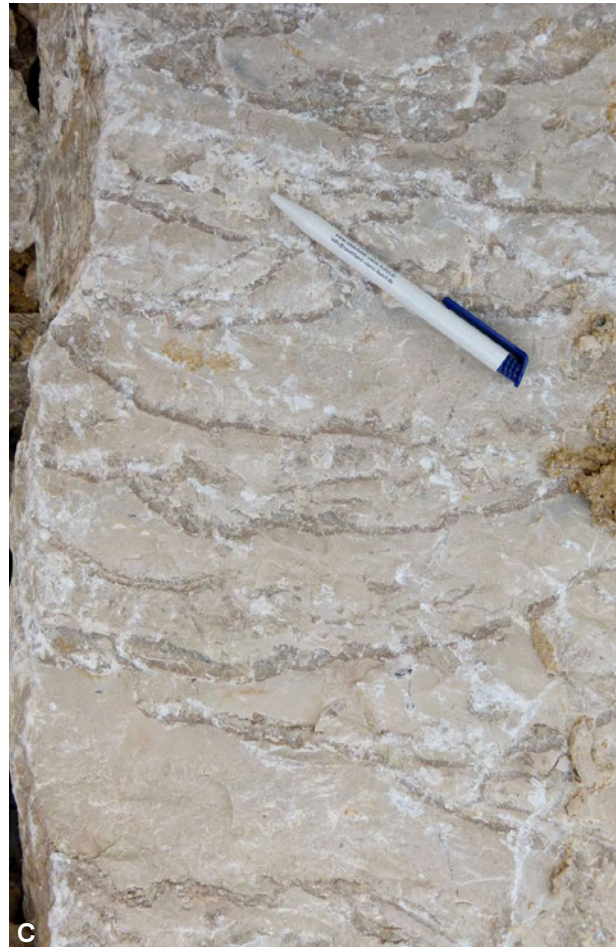
Abb.2-2-41: A) Kalkstein bestehend aus Schwamm-Mikroben-Biohermen des Unteren Massenkalks von der Schwäbischen Alb bei Straßberg (Steinbruch Teufel, RG 7820-2), B) Typischer Kalkoolith der mittleren Hauptrogenstein-Formation bei Müllheim-Vögisheim (RG 8211-306), C) Kalkstein mit Korallenkolonien in mikritischer Matrix der Korallenkalk-Formation aus dem Steinbruch Huttingen (RG 8311-3).
