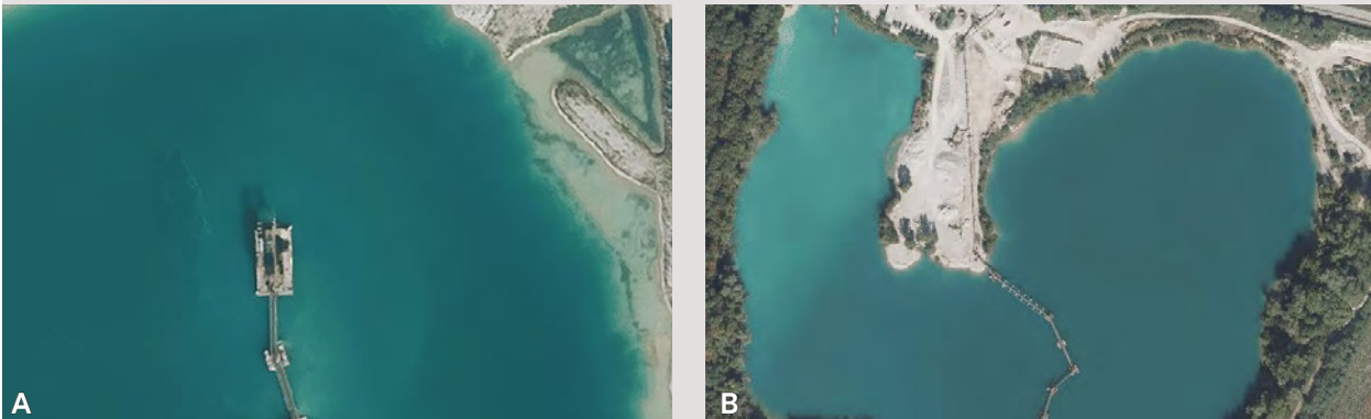
Abb. 2.2-22: A) Mobilisation des Feinanteils im Sediment durch Entnahme mittels schwimmendem Greiferbagger. Mehr als 50 % der Ton-Schluff-Fraktion verbleiben bei der Entnahme im Wasserkörper. Anlage von Flachwasserzonen mit Feinsedimenten (Waschschlamm). B) Einleitung von Waschschlamm in ein vom Gewinnungssee abgetrenntes Absetzbecken (hellerer Bereich westl. der Landzunge). Datenquelle: LGL, www.lgl-bw.de , www.govdata.de
