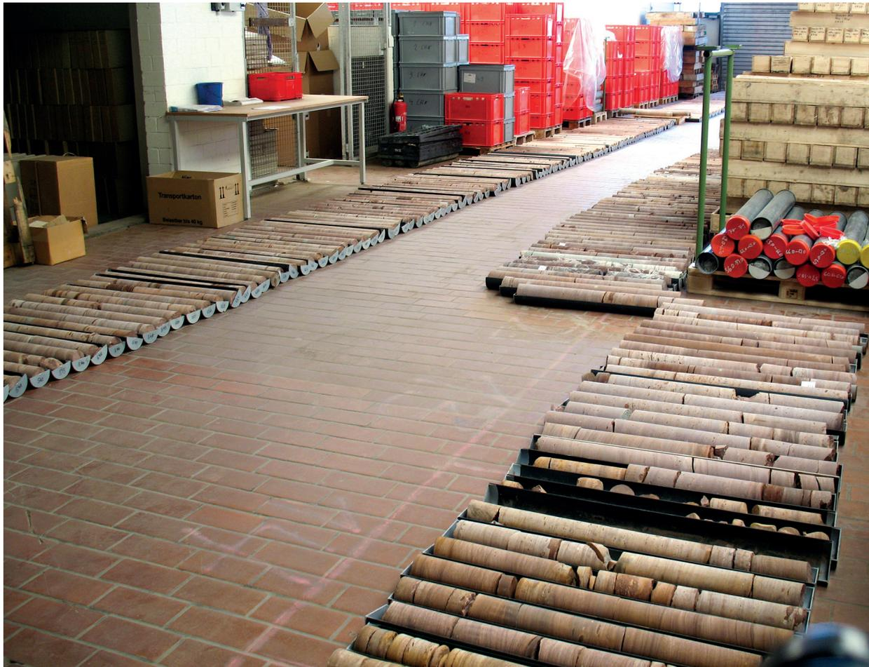
Abb. 3: Bohrkernauslage des Buntsandstein-Profiles der Bohrung Ensingen E15 (BO7019-2042).
