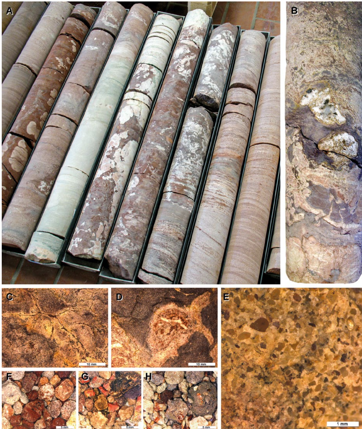
Abb. 26: Faziesbilder aus Violetten Horizonten des höheren Buntsandsteins. A. Karneoldolomit-Horizont smVH2 aus zwei aufgestapelten Paläoböden in der Bohrung Ensingen (BO7019-2042). Der Zettel markiert die Untergrenze über der Heidenstein-Subformation der Vogesensandstein-Formation, darüber (oben und links im Bild) folgt ein 2,4 m mächtiger Dolomitkrustenboden, der erosiv gekappt ist und von gebleichtem Sandstein überlagert wird. Den Abschluss bildet links ein rotbrauner feinsandiger Tonschluffstein mit Dolomitknollen. B. Pedogene Kalk-Dolomitkrusten in tonig-schluffigem Feinsandstein, mit Kalzitdrusen in Lösungshohlräumen, die wahrscheinlich auf Anhydritknollen zurückzuführen sind; smVH2-Horizont (Ausschnitt), Bohrung BO6618-1371 Bammental, Bohrkerndurchmesser 10 cm. C. Rissgefüge mit hellen Karbonatzementen an Schichtunterseite und D. mehrphasig gebildete Karbonatkonkretion (Bohrkernwand), Bohrung BO6618-1375 Bammental. E. Zementgestütztes Korngefüge in einem durch pedogene Karbonatkruste zementierten Sandstein, Bohrung BO7318-2891 Gültlingen. F-H. Beispiele für Bohrgut aus dem smVH2-Horizont (Cuttings), Maßbalken je 5 mm breit, F. mit gelbbraunen dolomitischen und gebleichten Sandsteinen und rotem Tonschluffstein, BO6618-1245 Bammental, G. mit violetten Sand- und Schluffsteinen und Karneolsplittern, BO7017-1638 Mutschelbach, H. mit violetten und gebleichten Sandsteinen, BO8314-291 Bannholz.
