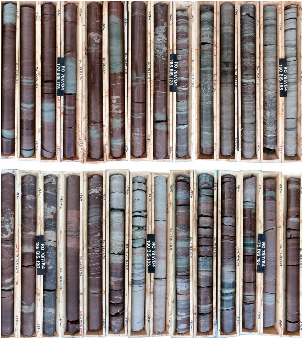
Abb. 53: Bohrkern der Bohrung Horgen (BO7817-978) vom Niveau des smVH2-Horizonts (unten links, mit Dolomitknollen) bis zum basalen Muschelkalk (oben rechts, Plattendolomit muPD und Liegende Deckbänke muLDB). Erschlossen ist der gesamte Obere Buntsandstein aus Plattensandstein- (soPL) und Rötton-Formation (soT; vgl. Abb. 46).
