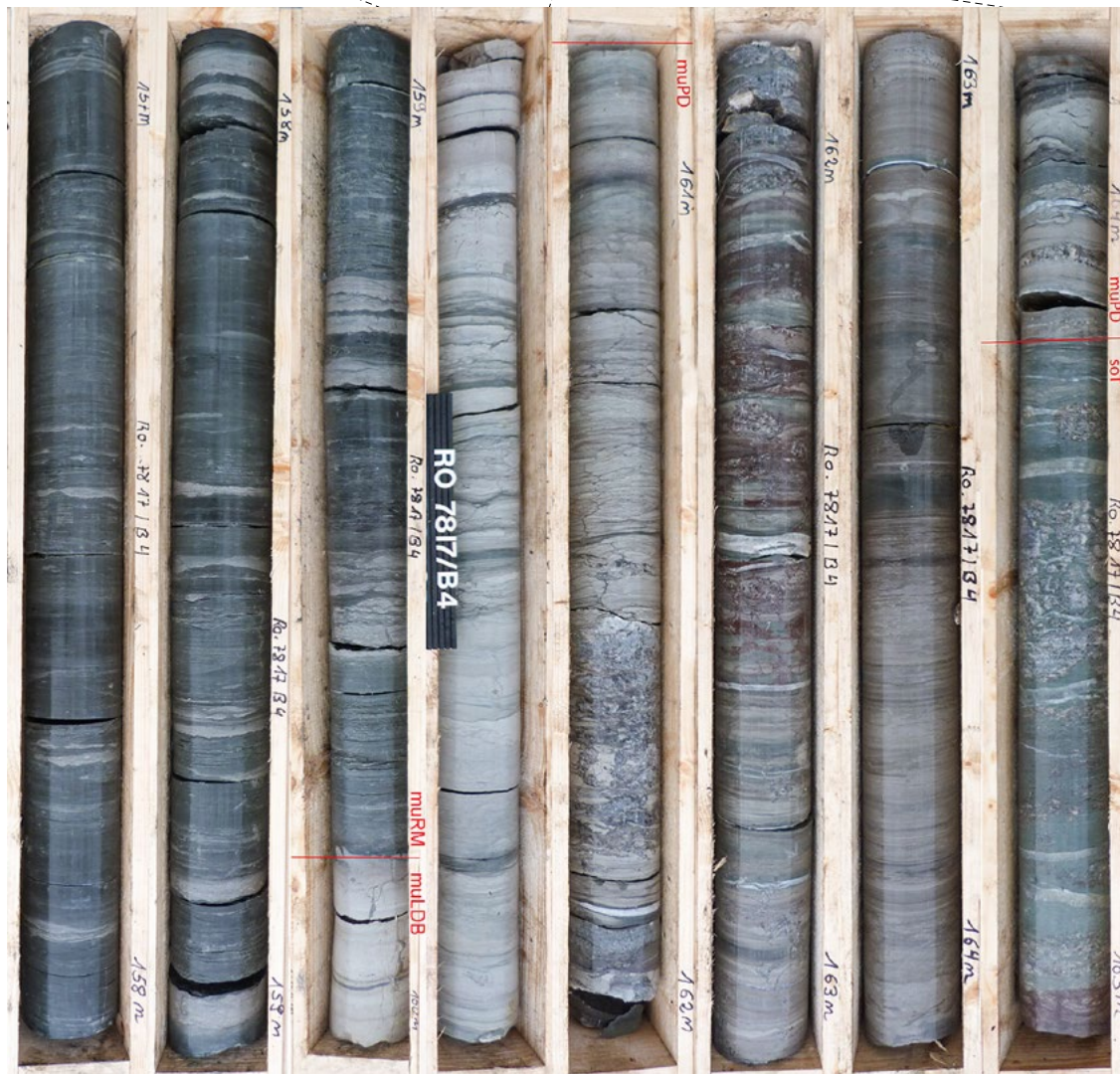
Abb. 29: Faziesabfolge bei der Transgression des Muschelkalk-Meeres über die Rötton-Ebene (schematisch, oben). Unten: Sedimente der Röt-Muschelkalk-Grenze in der Kernbohrung Horgen (BO7817- 978; Fotos: J. Wittenbrink/LGRB) unweit Rottweil. Im Rötton (rechts, Liegendes) und dem darüber folgenden Plattendolomit sind graue Gipsknollen eingelagert (161,5–163 m, 164,4–165 m). Die gestrichelten Linien zeigen die Position der am Bohrkern eingezeichneten Leithorizont-Grenzen (rot) zum Fazieschema.
