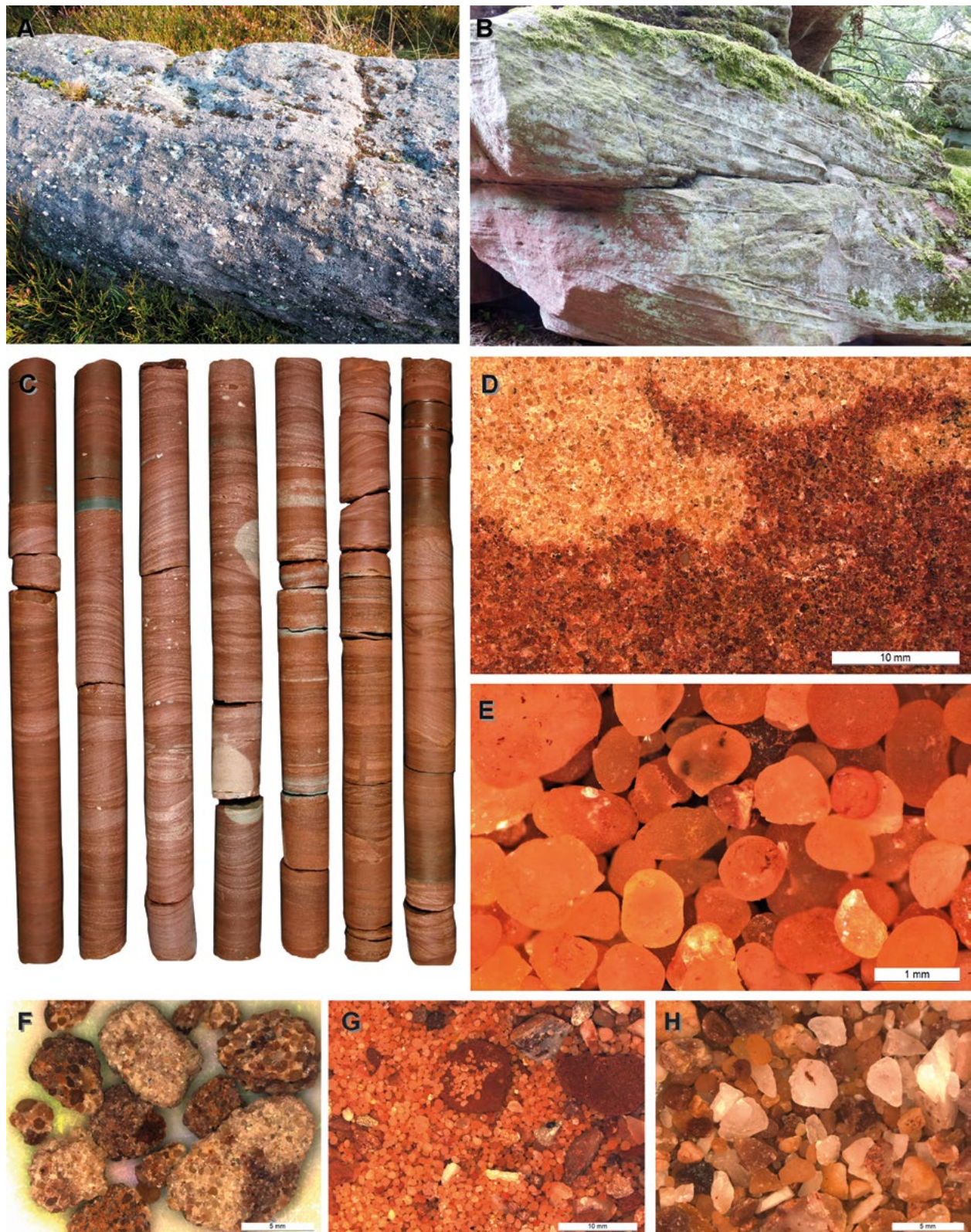
Abb. 42: Aufschlussbilder der Schliffkopf-Gröbelsandstein-Subformation. A. Gröbelsandstein mit Anreicherung von Geröllen entlang von Schrägschichtungsblättern, Schliffkopf bei Baiersbrunn im Schwarzwald. B. Schräggeschichteter geröllfreier Grobsandstein, Waldbrunn-Strümpfelbrunn bei Eberbach (Foto T. Huth). C. Schwach geröllführende Sandsteine im Kern der Bohrung Ensingen (BO7019-2042: 524–531 m, Hangendes links oben) im Bereich der Folgengrenze s3/s4 (nach Gammalog-Korrelation, über der Tonschluffsteinlage rechts oben). D. Grobsandstein mit Bleichungsflecken, überwiegend gut gerundeter Grobsand, Bohrung Ensingen (BO7019-2042, 504,7 m). E. Gut bis sehr gut gerundeter Grobsand, Bohrung Wallburg (Ausschnitt aus G). F–H. Bohrgut aus der Schliffkopf-Gröbelsandstein-Subformation, F. gut gerundete Grobsand-Körner in mittelsandiger Matrix, BO6620-1500 Mosbach, 121 m; zerbohrter Grobsandstein mit Tonschluffstein-Intraklasten, BO7713-399 Wallburg, 116 m; zerbohrter Gröbelsandstein mit zerschlagenen Geröllen, BO7713-399 Wallburg, 100 m.
