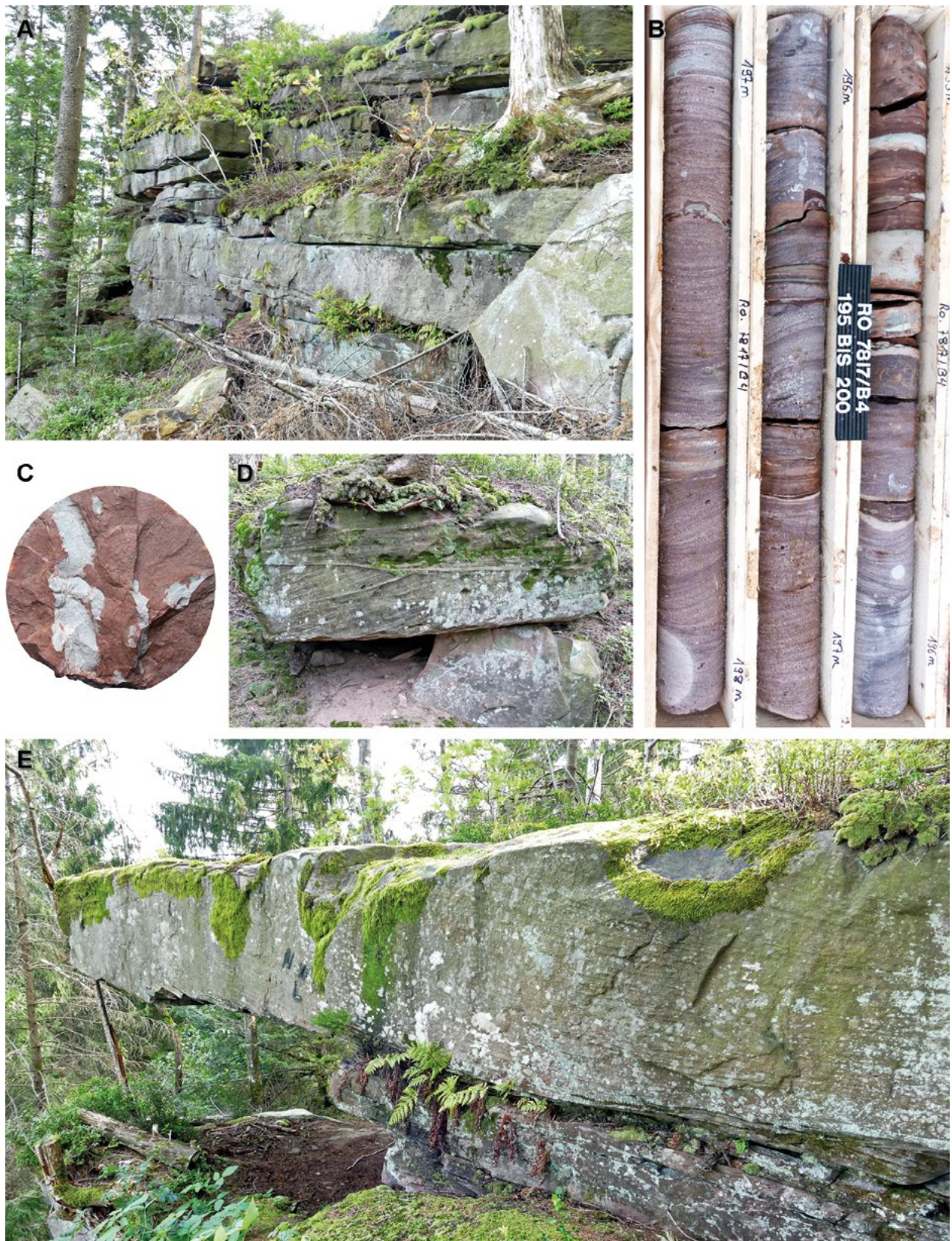
Abb. 25: Faziesbilder aus der Heidenstein-Subformation der Vogesensandstein-Formation. A. Unregelmäßig-bankige Rinnenfüllungen aus Mittelsandsteinen am Heidenstein bei Oberharmersbach (BO7514-442). B. Wechselnd schräggeschichtete Grobsandsteine an der Basis der Heidenstein-Subformation in der Bohrung Horgen (BO7817-978). C. Kernscheibe aus rotbraunem feinsandigem Tonschluffstein mit graugrünen Entfärbungszonen aus der Heidenstein-Subformation von Bammental (BO6618-1371). D–E. Mittelsandsteine mit fluvial geprägter Schrägschichtung am Heidenstein, Heidenstein-Subformation; D. Planare und flachwinklige Schrägschichtung, E. großdimensionale konkave Schrägschichtung, an Bankoberfläche gekappt, Schüttungsrichtung Nordost.
