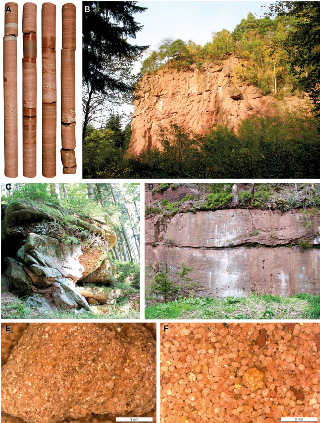
Abb. 39: Aufschlussbilder des Badischen Bausandsteins. A. Bohrkern der Bohrung Ensingen (BO7019-2042: 692–696 m, Fotos O. Wendt), Wechsel von Mittel- und Grobsandsteinen mit geringmächtigen Tonschluffstein-Zwischenlagen, aus denen auch Intraklasten aufgearbeitet in den Sandsteinen liegen. B. Ehemalige Steinbruchwand in amalgamierten Rinnensandsteinen des Badischen Bausandsteins, oben stellenweise geröllführend (Übergang in Schliffkopf-Geröllsandstein-Subformation) bei Heimbach unweit Emmendingen. C. Lössig ausgewitterter „Kugelsandstein“, Felsen am Reutiner Berg bei Alpirsbach. D. Bankige Rinnensandsteine mit seitlich auskeilenden Resten von Feinsedimenten unter der Rinnenbasis, ehem. Steinbruch bei Loßburg unweit Freudenstadt. E–F. Bohrgut aus dem Badischen Bausandstein (Gesteinsbruchstück und aufgebohrter Sand), Bohrung Peterstal (BO7515-331, 14 m).
