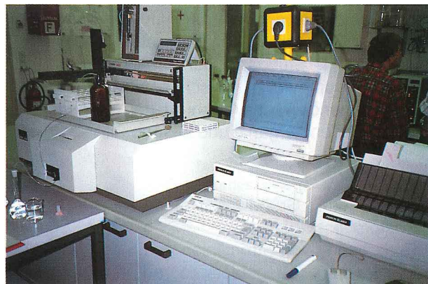
Serienmessung von Fluoreszenz-Farbstoffen in Grundwässern mit Fluoreszenz-Spektrometern Mit dem Gerät links (Hitachi F-4000) wird seit Jahren gearbeitet, das neue Gerät rechts (Perkin Elmer CS 50) erweitert die Meßkapazität erheblich.
