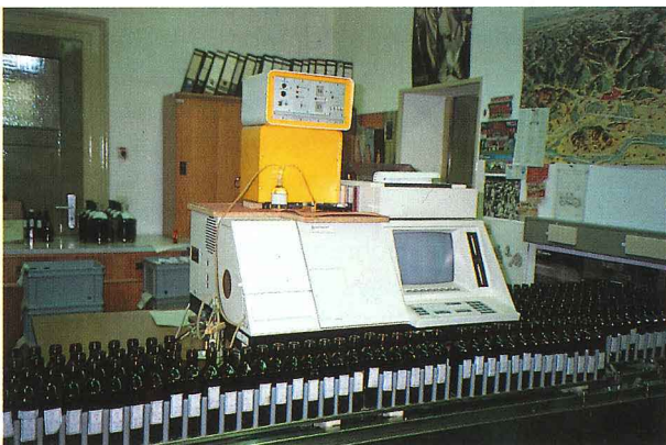
Serienmessung von Fluoreszenz-Farbstoffen in Grundwässern mit Fluoreszenz-Spektrometern Mit dem Gerät links (Hitachi F-4000) wird seit Jahren gearbeitet, das neue Gerät rechts (Perkin Elmer CS 50) erweitert die Meßkapazität erheblich.
