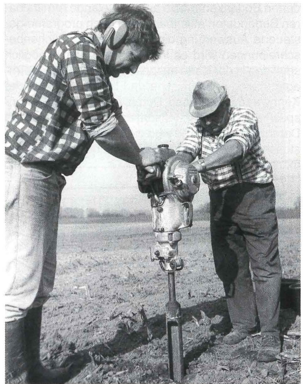
Bodenprobenahme mittels Zweitakt-Schlaghammer mit Rammkernsonde ( \varnothing 76/60 mm, max. Bohrtiefe 8 m) im Wasserschutzgebiet Donauried, Landkreis Ulm
