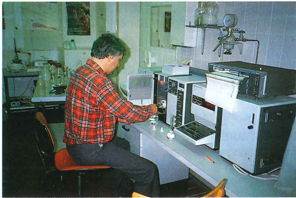
Bestimmung der Elemente Na, K, Ca, Mg, Fe und Mn in Grundwässern mit einem Atomabsorptionsspektrometer (Philips SP 9)
