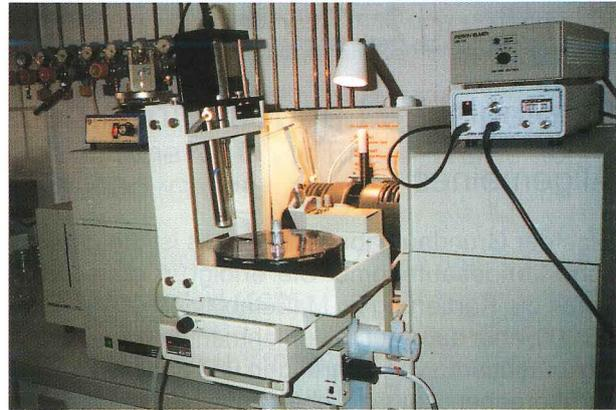
Abb. 10: Graphitrohfen mit Ultraschallsonde des AAS
