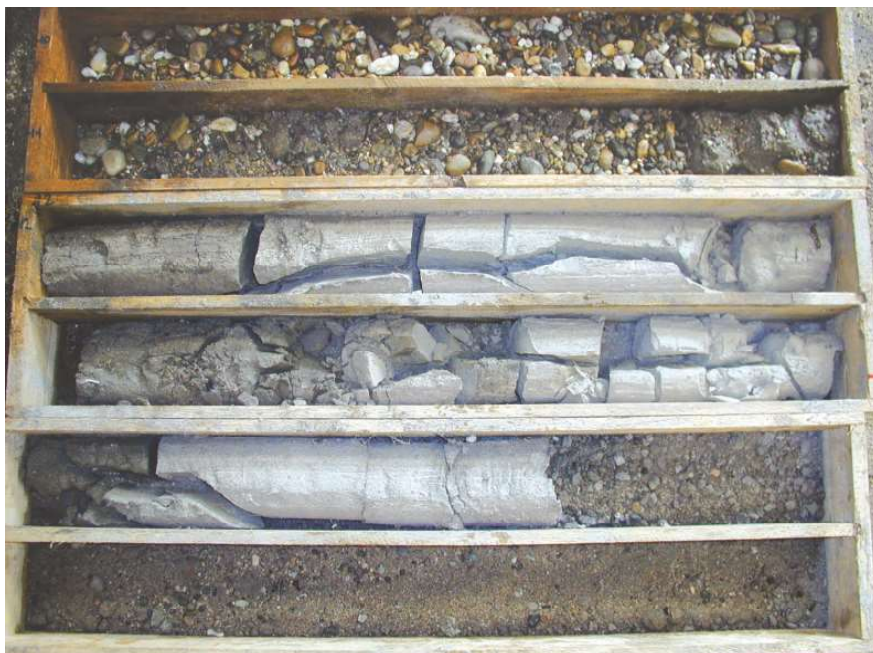
Abb. 9.21 Oberer Zwischenhorizont (OZH) in der Bohrung BK 1A HAUF, 10 – 16 m u GOK (LGRB-Archiv-Nr. Bo 6816/797), darüber die Obere kiesig-sandige Abfolge, darunter die Mittlere sandig-kiesige Abfolge.
