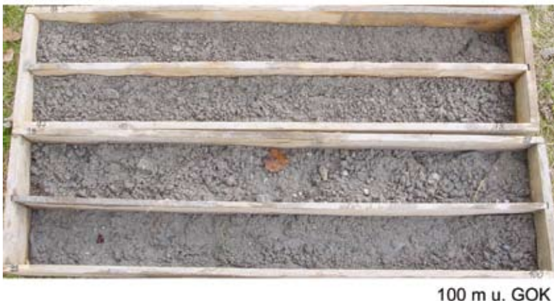
Abb. 9.25 Untere sandig-schluffige Abfolge in sandiger Ausbildung in der Bohrung P6/2006 Wiesloch, 96 – 100 m u. GOK (LGRB-Archiv-Nr. Bo 6717/1219).
