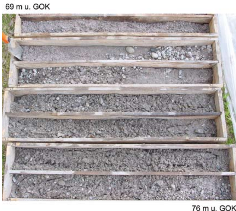
Abb. 9.22 Mittlere sandig-kiesige Abfolge in der Bohrung Wiesloch P6/2006 (69 – 76 m u. GOK, LGRB-Archiv-Nr. Bo 6717/1219).
