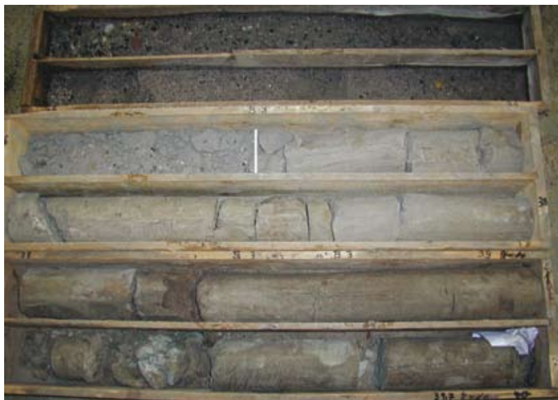
Abb. 9.24 Untere sandig-schluffige Abfolge in tonig-schluffiger Ausbildung in der Bohrung BK 3A HAUF 34-40 (LGRB-Archiv-Nr. Bo 6816/797), darüber die Mittlere sandig-kiesige Abfolge.
