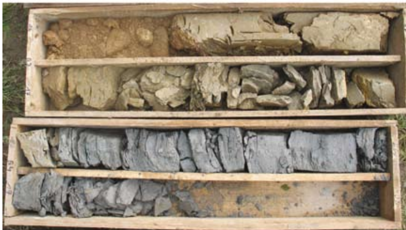
Abb. 9.19 Der Festgesteinsuntergrund besteht südlich des Kaiserstuhls meist aus oligozänen Tonmergelsteinen (grau) mit graubraunen Verwitterungsfarben im Übergangsbereich zur darüber liegenden Breisgau-Formation (Bohrung Kaserne Müllheim, GWM 1, LGRB-Archiv-Nr. Bo 8111/968).
