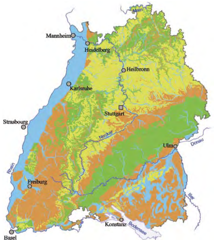
Abb. 2.1-1 Klassifikation der hydrogeologischen Einheiten nach Gebirgsdurchlässigkeit (in Anlehnung an Tab. 2.1-1, Abkürzungen s. dort).
