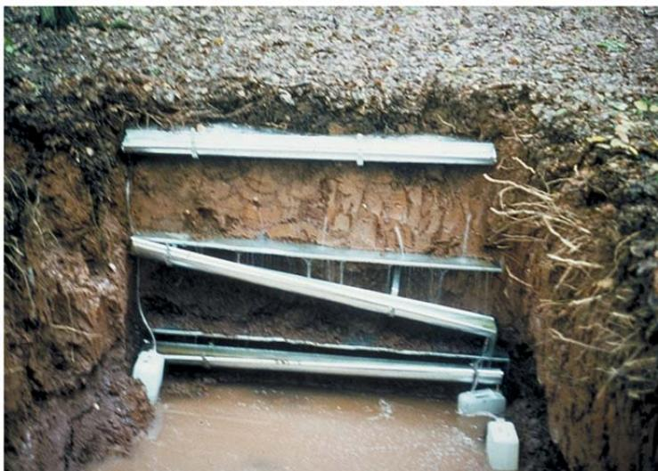
*Abb. 1: Zwischenabfluss (SSF) in präferenziellen Fließwegen – Beregnungsversuch auf Tonböden (Pelosole) am Hang unter Wald (Schönbuch bei Herrenberg).*
