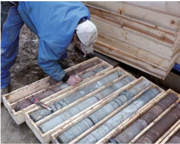
Abb. 6.2-5: In Kernkisten gelagerte Gesteinsbohrkerne werden nach der Entnahme aus dem Kernrohr direkt an der Bohrstelle mit Bezeichnung der Bohrung, Tiefe und Bohrrichtung beschriftet. In dieser Form sind sie gut und sicher zu transportieren, auszuwerten und zu lagern. Die im Bild gezeigten 1 m langen Kerne sind 10 cm dick und ermöglichen die Durchführung fast aller erforderlichen petrographischen, geochemischen und gesteinsphysikalischen Untersuchungen.
