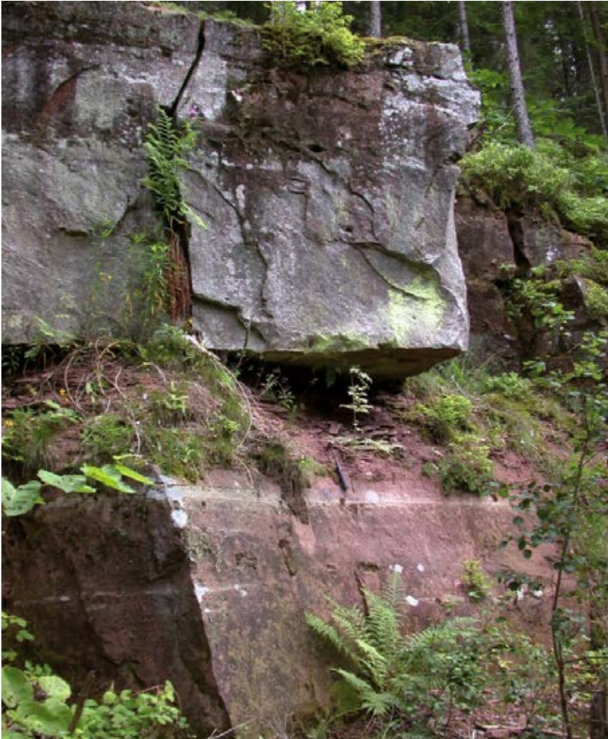
Abb. 6.4-2: In den ausgedehnten Wäldern des Nordschwarzwalds sind nicht selten Klippen, Weganschnitte oder kleine Steinbrüche zu finden, die einen guten Einblick in Gesteinsbeschaffenheit, Bankmächtigkeiten und Blockgrößen erlauben. Der dickbankige, fein- bis mittelkörnige Quarzsandstein der Bausandstein-Formation (Unterer Buntsandstein) bei Baiersbronn könnte leicht gewinnbares Material für Steinmetz- und Bildhauerarbeiten liefern. Das durch Kartierung abgrenzbare Vorkommen von ca. 11 ha Größe und bis 45 m Mächtigkeit könnte – wie andere Vorkommen im Nordschwarzwald – eine interessante Sandsteinlagerstätte enthalten (RG 7416-112; KMR 50 Freudenstadt: KESTEN & WERNER 2006).
