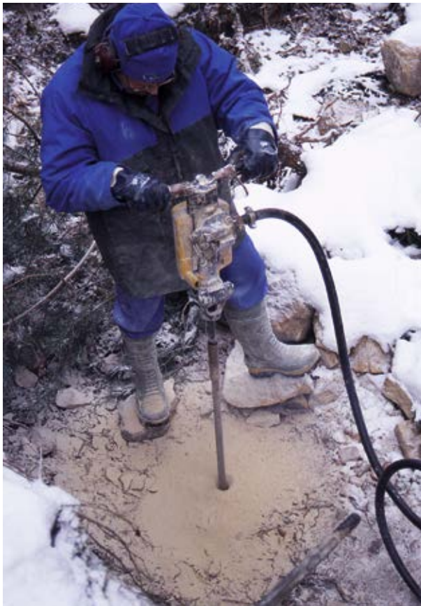
Abb. 6.2-3: Pressluftangetriebene Meißelbohrung; flache Vollbohrungen sind geeignet für die Ermittlung der Mindestmächtigkeit einer Schicht und für eine erste Einschätzung der Verbandsfestigkeit des Gesteins.
