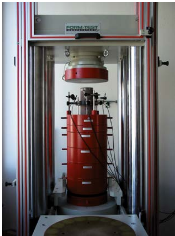
Abb. 6.3-2: Laboreinrichtung (Triaxialpresse) zur Bestimmung der Druckfestigkeit von Gesteinskernen.
