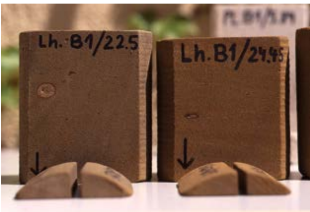
Abb. 6.2-6: Bohrkernabschnitte ( D = 10\text{ cm} ) für die gesteinsphysikalische Analyse mit Angabe der Bohrungskurzbezeichnung, der Bohrtiefe und der Bohrrichtung; davor Kalottenabschnitte für die geochemische Analytik und die Anfertigung eines Gesteinsdünnschliffs. Alle Daten zusammen erlauben eine gute Beurteilung der Gesteinseigenschaften.
