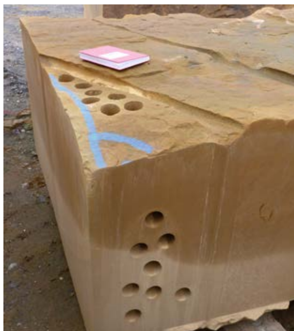
Abb. 6.3-1: Für gesteintechnische Untersuchungen an einem zweiseitig angesägten Rohblock wurden Bohrkern senkrecht und parallel zur Schichtung (im Foto nicht erkennbar) entnommen. Für das untersuchte und durch einen Probeabbau erschlossene Sandsteinlager lagen bislang keine Daten vor; das Gestein soll für hochwertige Renovierungsarbeiten am Ulmer Münster eingesetzt werden. Daher ist eine hohe Zahl von Gesteinsproben sinnvoll.
