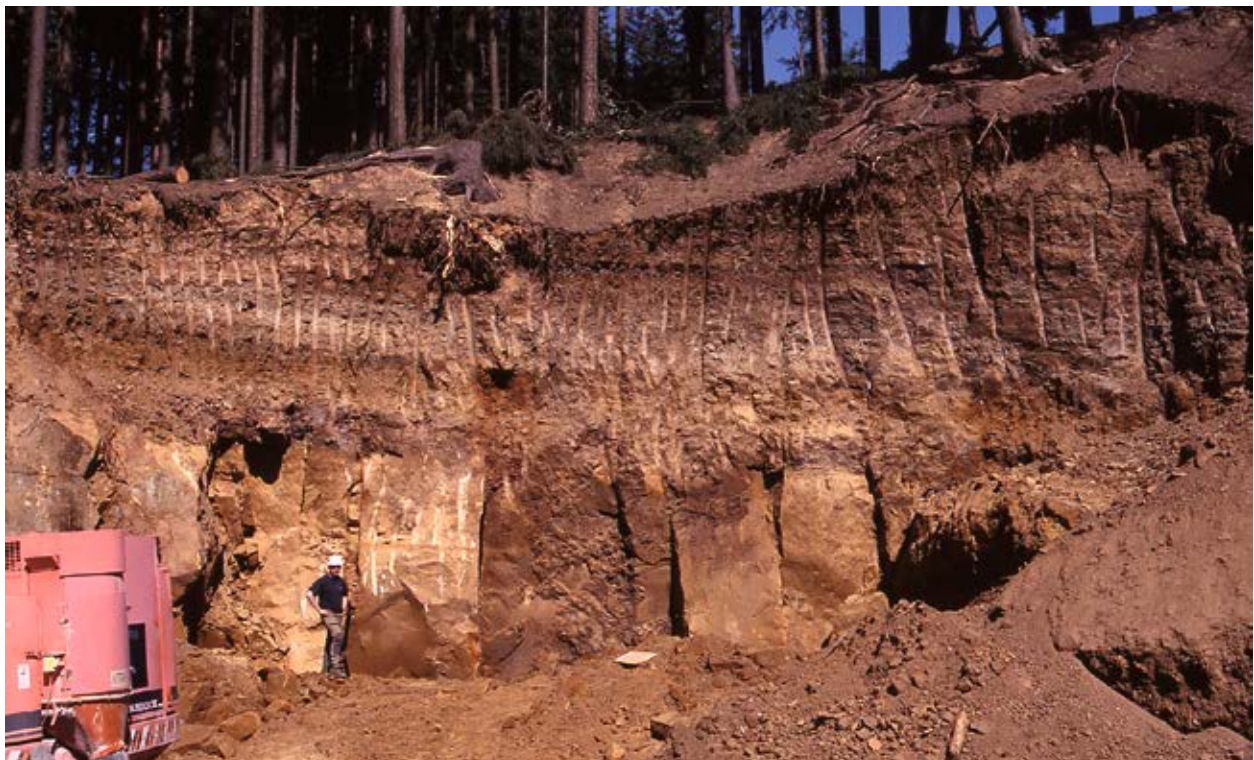
Abb. 6.2-9: Nach Entfernen der tonigen Abraumschichten mittels Hydraulikbagger wird das Sandsteinlager sichtbar. Nun können auch die Trennflächen wie Klüfte und Lagerfugen sowie die Rohblockgrößen ermittelt werden. Probeabbau im Eisensandstein.
