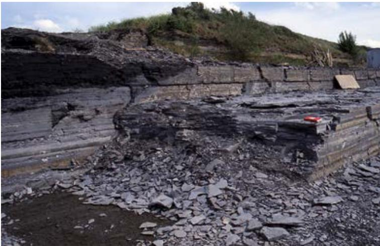
Abb. 4.19-7: Abbau des Fleins als Naturwerkstein im Steinbruch Ohmden I (Fa. Kromer, RG 7323-2), die 7–8 m mächtigen Posidonienschiefer werden abgeräumt und der Steinbruch damit wieder verfüllt.
