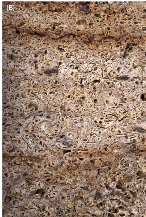
Abb. 4.20-1: Der Randengrobkalk, ein grober, miozänzeitlicher Schalenrümmerkalkstein: (A) Musterplatten aus den Steinbrüchen bei Wiechs am Randen (links) und bei Tengen (rechts). (B) Fassadenplatte am Rathaus in Tengen.
