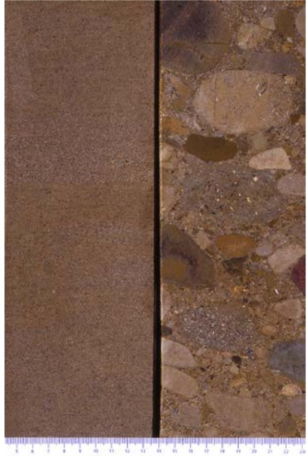
Abb. 4.17-4: Bohrkern aus der Erkundungsbohrung am Steinbruch Pfaffenweiler (vgl. Abb. 4.17-9 und -26); links der Pfaffenweiler Kalksandstein in Bildhauerqualität, rechts das grobe Tertiärkonglomerat – Ausschnitte aus den Bohrkernabschnitten 28–29m und 26–27m.
