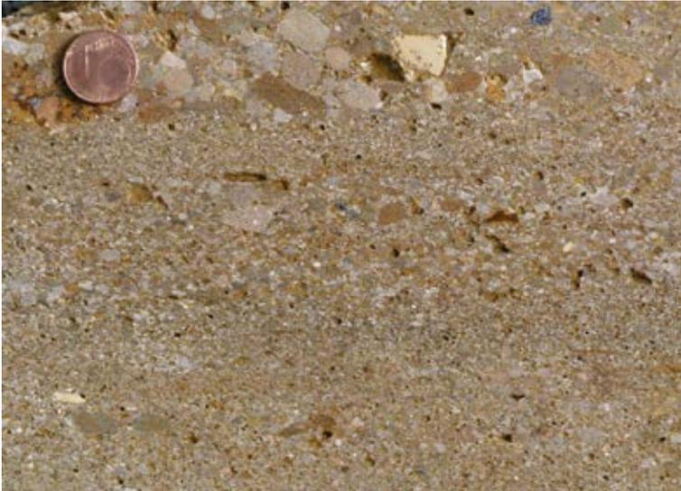
Abb. 4.17-5: Kalksandstein aus Britzingen mit hohem Anteil an kantigen Bruchstücken in Fein- und Mittelkiesgröße. Probe aus dem alten Steinbruch nordöstlich des Dammbachgrabens.
