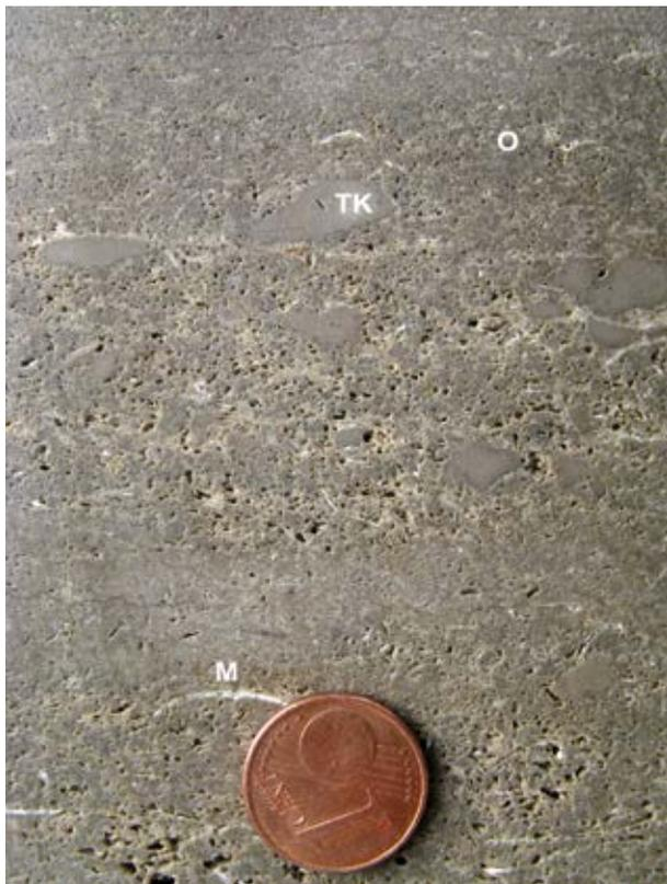
Abb. 4.16-34: Handstück vom Döggingen-Oolith aus einem Profil in der Wutachschlucht (Belegsammlung LGRB): Gelblichgrauer oolithischer Kalkstein (O) mit lagig angeordneten feinkörnigen Kalkschlammgeröllen (TK, Mitte rechts; Entstehung: Sturmlage) und einzelnen Muschel- oder Brachiopodenschalen (M). Auch hier erhält die Gesteinsoberfläche durch die Herauslösung der Ooide eine schaumig-poröse Struktur.
