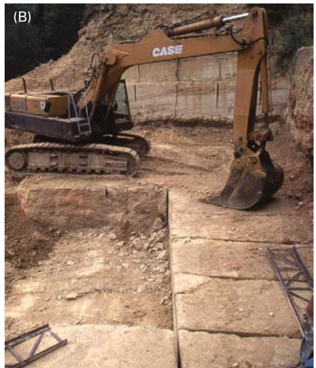
Abb. 4.20-8: Gewinnung von Randengrobkalk im Steinbruch O. Meier bei Tengen: (A) Oberes Lager und Top des Mittleren Lagers, getrennt durch Sande, Blick nach Westen (Foto 2011). (B) Abbau im Mittleren Lager mittels Schwertsäge und Bagger (Foto 2009).
