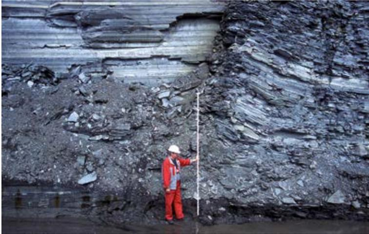
Abb. 4.19-6: Abbauwand mit dunklen Ton- und grauen Mergelsteinen im Steinbruch Dormettingen, in dem der Posidonienschiefer fast in seiner Gesamtmächtigkeit zur Herstellung von Portland-Ölschieferzement gewonnen wird (Fa. Holcim, RG 7718-4).
