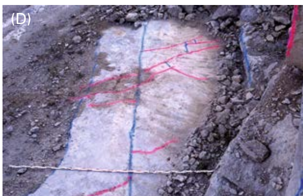
Abb. 4.8-9: Steinbruch Gauingen der Fa. Lauster Steinbau: (A) Werkhalle, errichtet in den 1930er Jahren von der Fa. A. Burrer, daneben Blocklager; (B) Neuaufschluss im Oberen Lager, März 2012; (C) Abbau mit der schwenkbaren Schrämsäge, hier Anlage eines Sohlschnitts; (D) Kluftmuster im Travertin des oberen Lagers, Blick auf eine Lagerfläche (Maßstab 3m).
