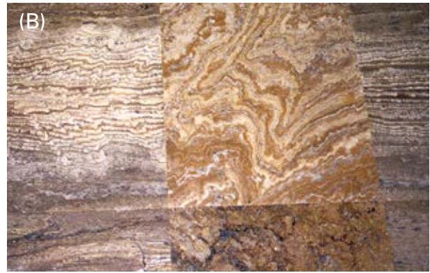
Abb. 4.6-3: Cannstatter Travertin, Oberflächen und Strukturen in Schnitten parallel oder spitzwinklig zur Schichtung: (A) Fassadenplatte mit sandgestrahlter Oberfläche; (B) Bodenplatten im Verwaltungsgebäude Lauster; (C) Ausschnitt aus einer Fassadenplatte an der Stuttgarter Staatsgalerie (Bildhöhe ca. 20cm).
