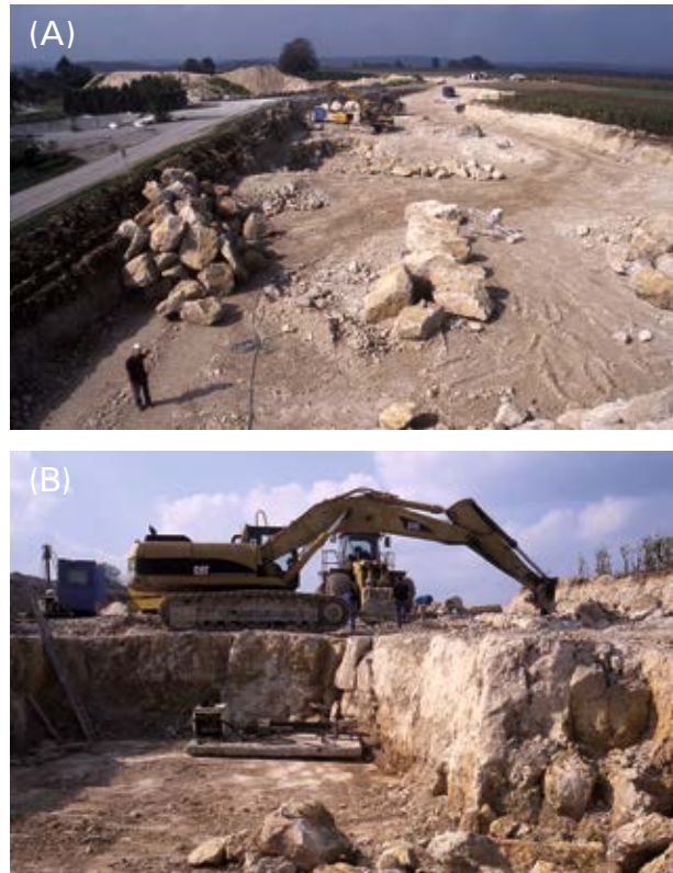
Abb. 4.8-13: Abbau von Sonderbucher Travertin bei Zwiefalten-Sonderbuch: (A) Im Sommer 2010 begonnener neuer Steinbruch der Fa. Traco, Bad Langensalza; links im Hintergrund die Halden des Steinbruchs der Fa. Schön & Hippelein; (B) Blick in den Neuaufschluss bei Sonderbuch; das Travertinlager ist am östlichen Rand der Lagerstätte nur etwa 2m mächtig.
