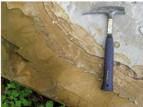
Abb. 4.7-8: Stark karbonatischer Eisensandstein aus Donzdorf in einem bei Bauarbeiten gewonnenen Block; im frischen Zustand noch hellgrau, im oberflächennahen Bereich bereits kräftig rostbraun.
