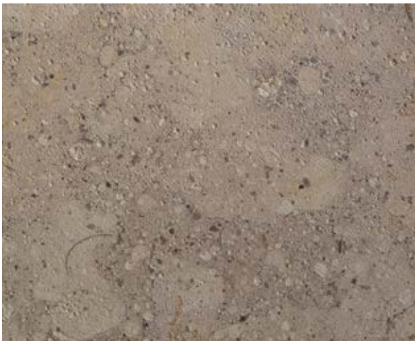
Abb. 4.8-5: Kreidiger Süßwasserkalkstein aus der Basischicht des oberen Werksteinlagers in Gauingen, mangels ausreichender Zementierung nicht polierfähig. In diesen Gesteinstyp (gelb in Abb. 4.8-3) sind die gut zementierten „Travertin“-Lager eingeschaltet. Bildbreite entspricht 11 cm.
