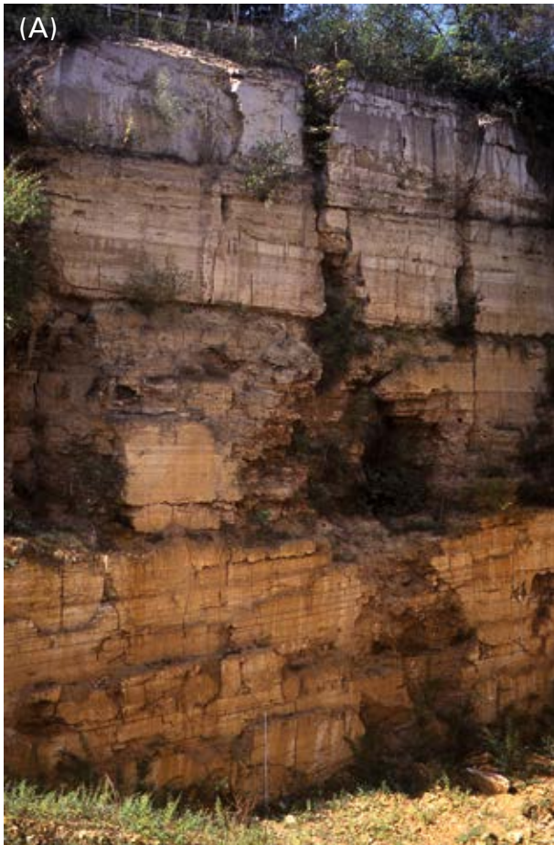
Abb. 4.6-11: Travertinsteinbruch der Fa. Lauster Steinbau, Bad Cannstatt: (A) Westwand des Steinbruchs Lauster mit Zone intensiver spalten- und höhlenartiger Verkarstung (Foto: Juli 2009); (B) Abbau des Travertins mit der Schwertsäge (März 2000); (C) Blick auf eine mit der Schwertsäge frisch freigelegte Wand im Cannstatter Travertin.
