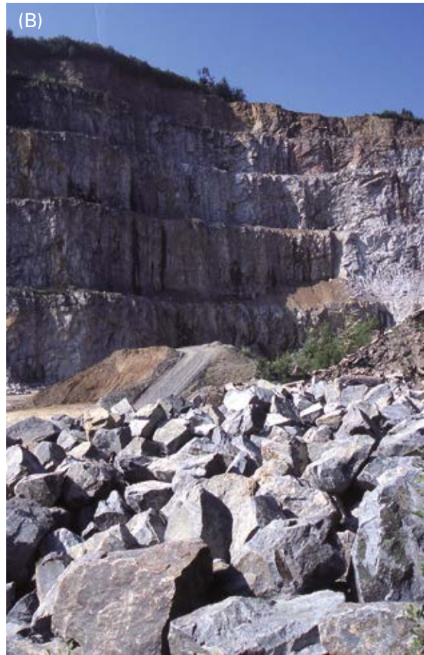
Abb. 4.9-3: Steinbruch Steinach (RG 7714-1) der Fa. Uhl bei Steinach: (A) Im über 100m hohen Steinbruch werden Flasergneise gewonnen. (B) Nach Sprengungen werden große Gesteinsblöcke für den Hang- und Uferverbau aussortiert, die gegebenenfalls als Naturwerksteine verwendet werden können.
