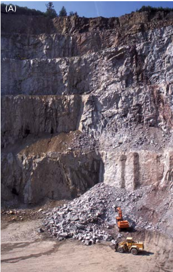
Abb. 4.9-3: Steinbruch Steinach (RG 7714-1) der Fa. Uhl bei Steinach: (A) Im über 100m hohen Steinbruch werden Flasergneise gewonnen. (B) Nach Sprengungen werden große Gesteinsblöcke für den Hang- und Uferverbau aussortiert, die gegebenenfalls als Naturwerksteine verwendet werden können.
