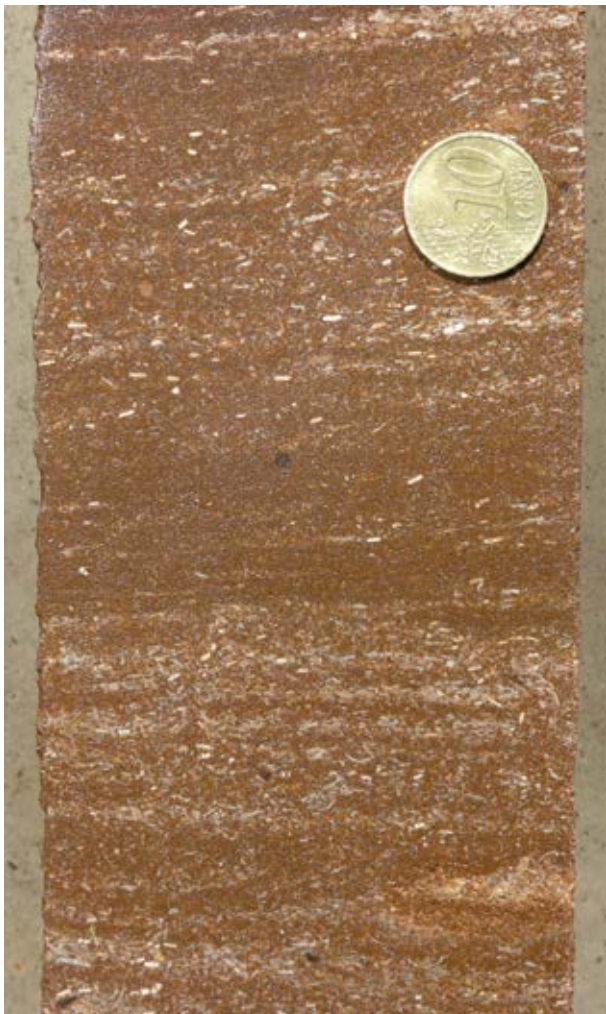
Abb. 4.7-4: Der Mittel- bzw. Braunjura der Ostalb enthält auch wichtige Eisenerzlagerstätten; Bohrkern mit reichlich Brauneisenerz und Schalenbruchstücken, Bohrung BO7423/67 bei Wiesensteig, 201 m Tiefe.
