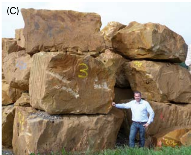
Abb. 4.7-12: Probeabbau im Eisensandstein-Vorkommen der Banzenmühle bei Lauchheim, Mai 2011 (durchführende Firma: Bamberger Natursteinwerke H. Graser): (A) Nach Entfernen der tonigen Abraumschichten wurden Blöcke aus dem weitständig geklüfteten, ca. 5 m mächtigen Eisensandsteinlager gelöst und mittels Bohrlafette zum Spalten vorbereitet. (B) Zerteilen der bis 50 m 3 großen Rohblöcke mittels hydraulischem Spaltgerät. (C) Rohblöcke aus Lauchheim im Werk der Fa. Graser, Bamberg; dort erfolgte zunächst die Probenahme für die gesteintechnischen Untersuchungen, dann die Vorfertigung der Blöcke für die Münsterbauhütte Ulm. (D) In der Münsterbauhütte Ulm im Jahr 2012 gefertigte Werkstücke aus Lauchheimer Eisensandstein – fertig zum Einbau.
