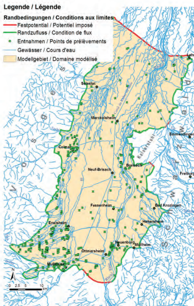
Abbildung 4.1: Modellgebiet und Randbedingungen (links), Modellnetz (rechts). Figure 4.1 : Limites et conditions aux limites (à gauche) et le maillage (à droite).
