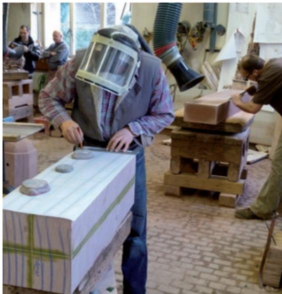
Abb. 3.2-39: Übertrag eines zeichnerischen Entwurfs auf einen Rohblock aus Lahrer Sandstein durch einen Bildhauer der Freiburger Münsterbauhütte.
