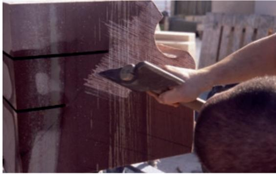
Abb. 3.2-38: Beilen einer gesägten Sandsteinfläche in einem modernen Steinmetzbetrieb; das Werkstück aus Neckartäler Hartsandstein ist für das Breisacher Münster bestimmt und erhält daher eine Oberflächenbearbeitung nach historischen Vorbildern. Fa. Armin Hellstern, Freiburg.
