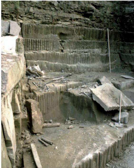
Abb. 4.15-7: Früherer Abbau des Lettenkeuper-Sandsteins im heute stillgelegten Steinbruch Neuenstein der Fa. Melchior aus Freudenbach. Über dem Sandsteinlager folgen dünnbankige bis plattige, schluffig-tonige Sandsteine sowie Schluff- und Tonsteine.
