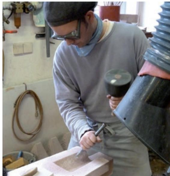
Abb. 3.2-41: Steinbildhauer beim Abtrag mit dem Zahneisen an einem angefeuchteten Werkstück aus Lahrer Sandstein. Die Absaugvorrichtung rechts im Bild verhindert die Verbreitung von Quarzfeinstaub.
