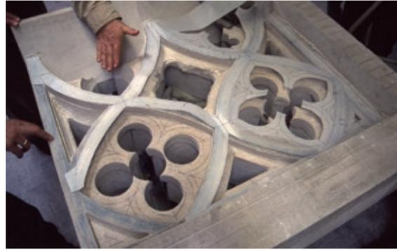
Abb. 3.2-40: Fertigung eines Maßwerks in der Ulmer Münsterbauhütte. Die in der Bauhütte aufbewahrten originalen Werkzeichnungen werden auf verzugsfreie Papier-schablonen übertragen, anschließend ausgeschnitten und mit der Reißnadel auf den Stein geritzt.
