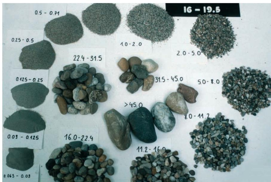
Abb. 26: Zur Untersuchung der Kiesvorkommen des Oberrheingrabens nach Korngrößen (mm) differenzierte Probe (aus einer LGRB-Erkundungsbohrung bei Sinzheim, Region Mittlerer Oberrhein)
