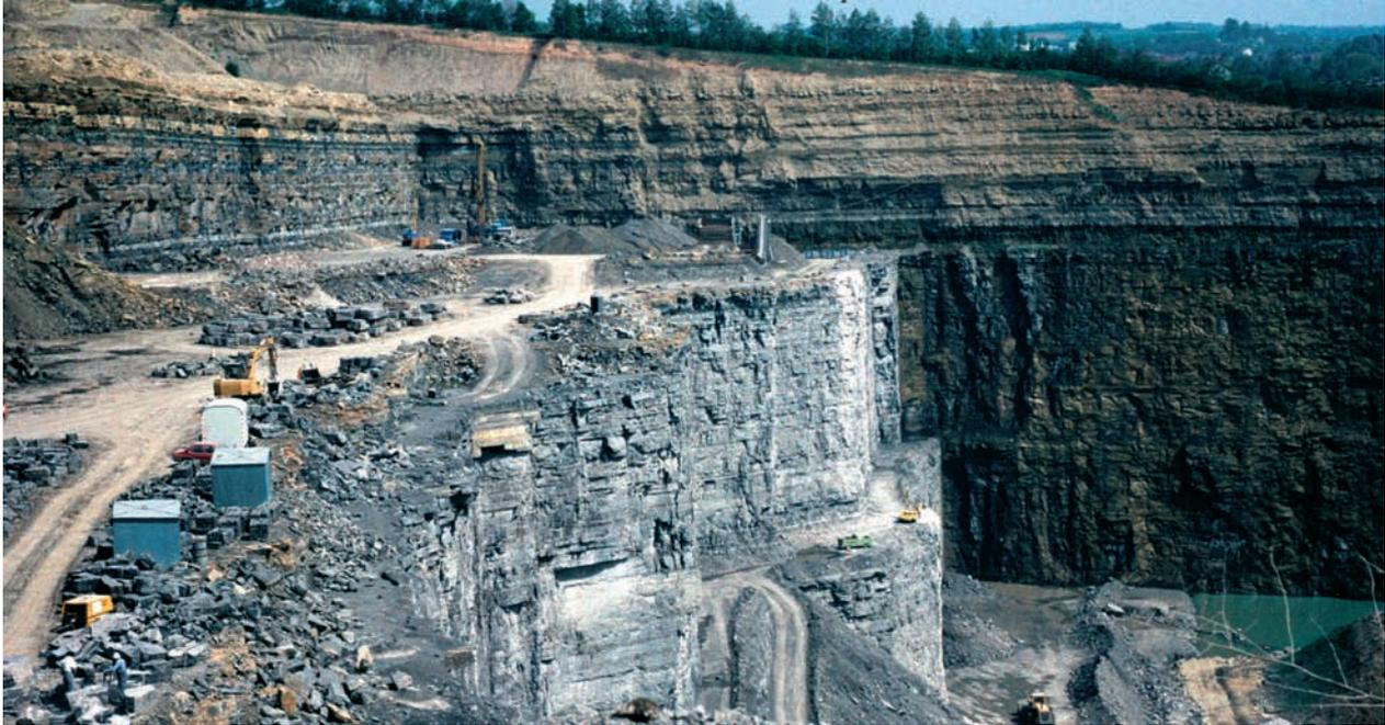
Abb. 6: Rund 70 m mächtige gebankte Kalksteine des Oberen Muschelkalks, überlagert von tonigen Sedimentgesteinen der Lettenkeuper-Formation; Steinbruch bei Gemmingen, nordöstlich von Eppingen
