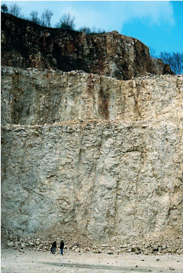
Abb. 7: Abbau in Massenkalksteinen des höheren Oberjuras bei Blaustein-Wipplingen. Diese meist sehr reinen Kalksteine neigen zu intensiver Verkarstung (obere Bildhälfte)
