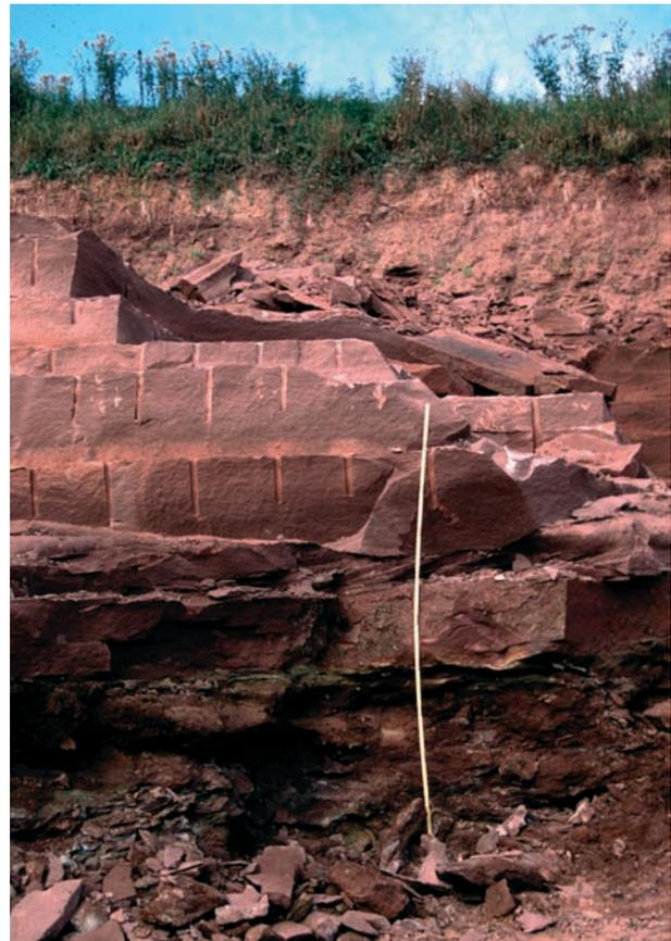
Abb. 12: Gewinnung von Werk- und Ornamentsteinen aus der Plattensandstein-Formation (Oberer Buntsandstein) im Schwarzwald
