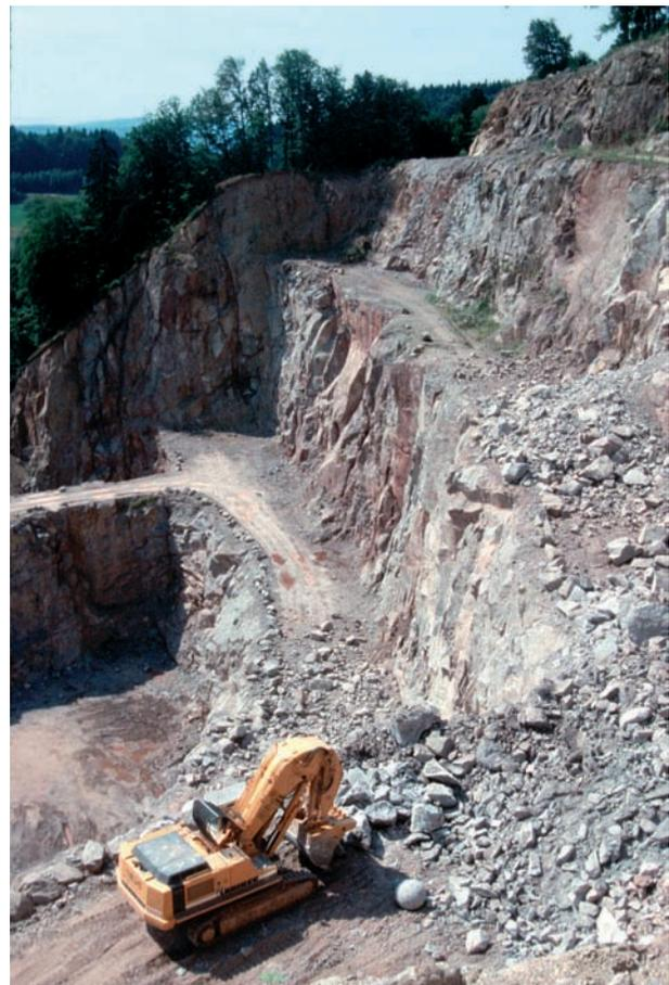
Abb. 10: Großer Steinbruch im Albgranit bei Göhrwühl (Südschwarzwald). Hier werden vornehmlich Schotter- und Splittkörnungen für den Hoch- und Tiefbau erzeugt
