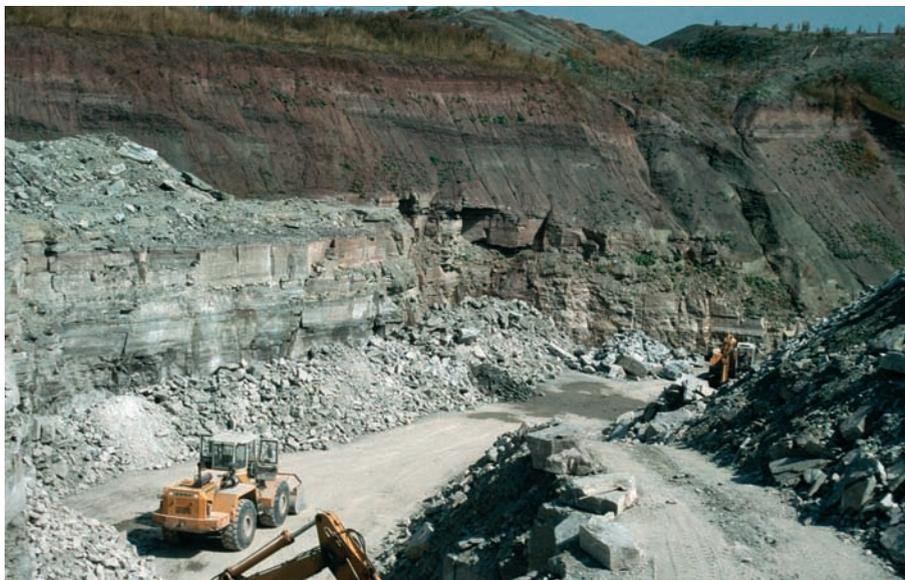
Abb. 3: Gipssteinbruch Haggenhof bei Roßfeld westlich von Crailsheim (Foto Herbst 2001). Deutlich ist der rasche laterale Wechsel von Gipssteinführung (in wirtschaftlicher Mächtigkeit) zu abgelaugten Bereichen – rechts im Bild – zu erkennen
