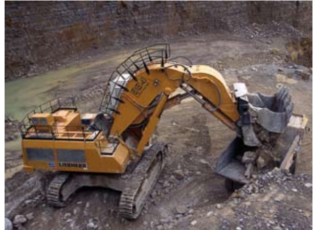
▼ Abb. 120 Abbau von Kalksteinen des Oberen Muschelkalks, Steinbruch bei Klengen (RG 7916-2) – Gewinnung durch Reißen mit einem Großhydraulikbagger.
