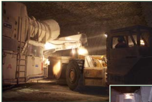
Continuous Miner ABM 30-CM – Übergabe geschnittenen Salzes auf einen Fahrschauellader.
