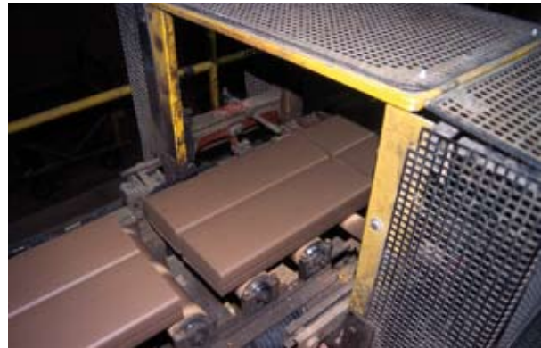
Abb. 142 Nach Homogenisierung des keramischen Rohstoffs und der Verdichtung in der Strangpresse werden die Stränge in für die weitere Produktion benötigte „Portionen“ geschnitten.
