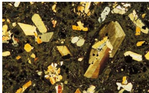
Abb. 81 Mikroskopisches Bild eines Kaiserstühler Phonoliths: Pyroxene bilden große Kristalle in einer dichten Grundmasse, in der sich auch nadelige Kristalle von Zeolithen verbergen (Bildbreite = ca. 3 mm, Gesteinsdünnschliff im polarisierten Licht).
