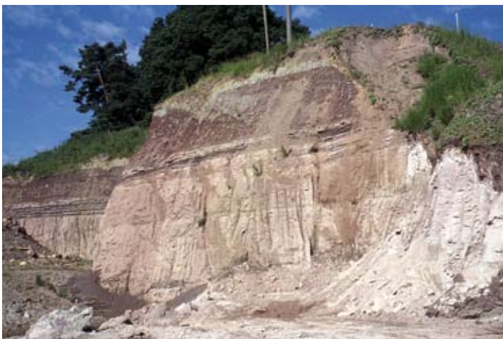
Abb. 21 Bei Meinhardt-Hohenstraßen werden angewitterte Sandsteine der Stubensandstein-Formation („Mürbsandsteine“) gewonnen und als Natursande der Körnungen 0/2 und 0/4 an die Baustoffindustrie verkauft. Sie werden von roten Tonsteinen überlagert (Gewinnungsstelle RG 6923-1, Lage vgl. Beilagenkarte).
