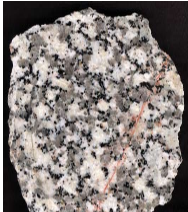
Abb. 39 Typischer hellgrauer bis rötlich-grauer Schwarzwald-Granit bestehend aus den Mineralen Feldspat (weiß, z. T. auch rötlich), Quarz (grau) und Biotit (schwarz). Das Bild zeigt den Schluchsee-Granit.
