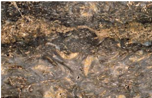
Abb. 33 Der in württembergisch Franken verbreitete sog. Krenshheimer Quaderkalk im Oberen Muschelkalk besteht vornehmlich aus Muschelschalen und stellt einen beliebten Naturwerkstein dar (Bildbreite = 6 cm).
