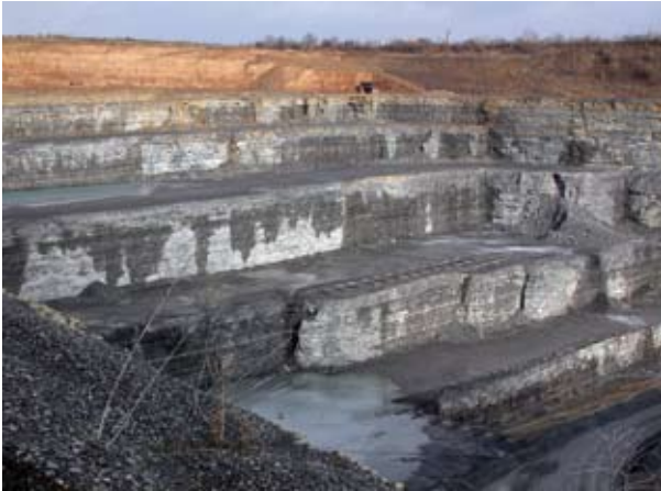
Abb. 30 Kalksteine des Oberen Muschelkalks: Diese dunkelgrauen Kalksteine unterscheiden sich deutlich von den Kalksteinvorkommen der Schwäbischen Alb. In einer Mächtigkeit von ca. 65 m werden sie z. B. im Steinbruch Talheim bei Heilbronn (RG 6821-4) gewonnen. Über den Kalksteinen liegt hellbrauner Lösslehm.
