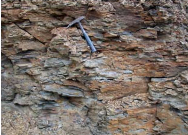
Abb. 55 Ton als Zuschlagstoff: Tonsteine der Opalinuston-Formation werden in der Tongrube Schömberg (RG 7818-3) im Zollernalbkreis abgebaut und für die Portlandzementherstellung ins Zementwerk Dotternhausen transportiert.
