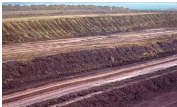
Abb. 53 Zur Herstellung grobkeramischer Produkte werden in der Tongrube Buchen-Hainstadt (RG 6422-2) Lösslehm und Röttone gemeinsam abgebaut.
