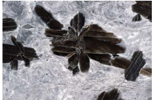
Abb. 10 Gips und Anhydrit gehören zu den Industriemineralen, ohne die modernes Bauen nicht mehr denkbar ist: Beispiel von „Blumengips“ in Anhydritstein. Angeschliffene Gesteinsplatte aus der stillgelegten Grube Haßmersheim (RG 6720-4, lange Bildseite = ca. 3 cm).
