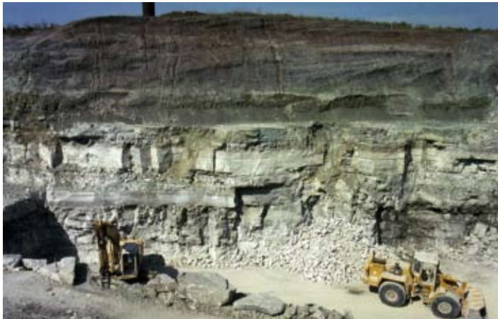
Abb. 77 Gipsbruch Crailsheim-Hagenhof (RG 6826-7). Über den 6 – 11 m mächtige Grundgipsschichten müssen insgesamt bis zu 12 m mächtige Gesteine des Bochingen-Horizontes und der Dunkelroten Mergel abgeräumt werden.
