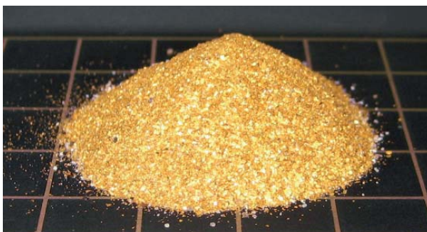
Abb. 222: Durch weitere mechanische Aufbereitung aus den Schwermineralsanden abgetrenntes Konzentrat von Rheingold.
