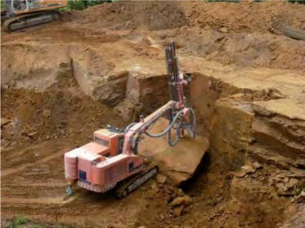
**Abb. 212:** Gewinnung von Eisensandstein bei Lauchheim, Probeabbau der Ulmer Münsterbauhütte, Mai 2011.
