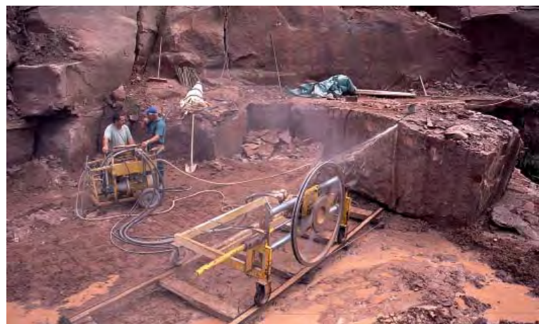
Abb. 157: Abbau von Sandstein für Steinmetz- und Bildhauerarbeiten, Buntsandstein der Lahr-Emmendinger Vorberge; im Bild eine Seilsäge zum Zerteilen der mittels Bohren und Spalten gewonnenen Sandsteinblöcke. Steinbruch im Bleichbachtal bei Kenzingen (RG 7713-3, Foto 2011).
