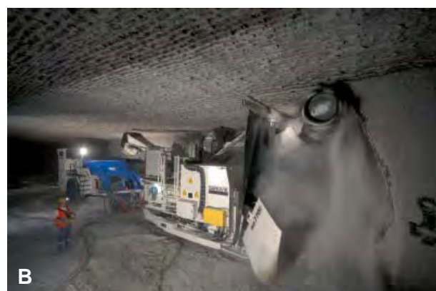
Abb. 125: Untertägige Steinsalzförderung in dem Bergwerk Heilbronn (RG 6821-5) mittels „Continuous Miner“: (A) Schneidende Gewinnung betrachtet von oben und (B) von der Seite.
