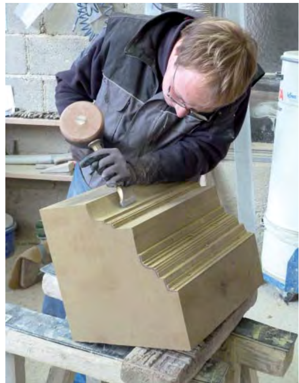
Abb. 114: Bearbeitung von Sandstein in einem Steinmetzbetrieb bei Eppingen-Mühlbach.
