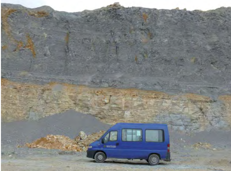
Abb. 176: Große Lagerstätten von Zementrohstoffen stehen auf der Ostalb ebenfalls in Abbau; durch Mischung von Mergelsteinen (im Bild dunkelgrau) und Kalksteinen (hellbeige) und durch Zusatz der meist auflagernden Sande der Molasse entsteht ein ideales Rohsteingemisch für die Portlandzementherstellung. Steinbruch Mergelstetten (RG 7327-1, Foto 2011) bei Heidenheim a. d. Brenz.
