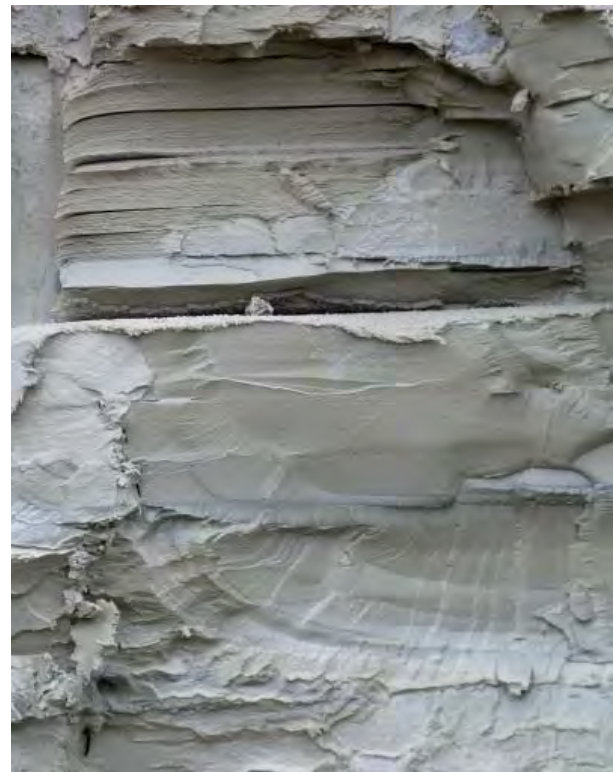
▼ Abb. 107: Gebänderte quartäre Beckentone in der Tongrube Großschönach südlich Pfullendorf, die mit tertiären Sedimenten gemischt und zu Hintermauerziegeln verarbeitet werden.
