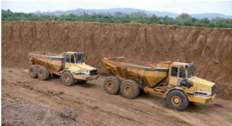
◀ Abb. 106: Lößlehm ist der in Baden-Württemberg am weitesten verbreitete Ziegeleirohstoff. In der Lehmgrube bei Leutenbach (RG 7122-5) wird Lößlehm in einer Mächtigkeit von max. 8 m abgebaut.
