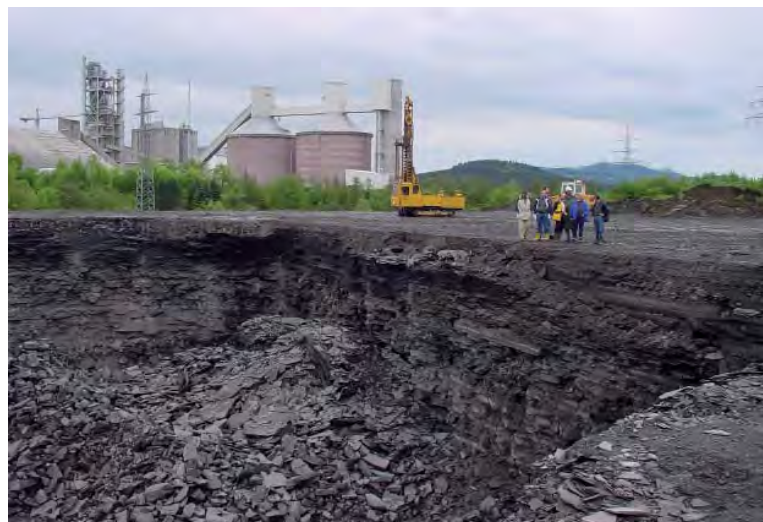
Abb. 101: Im Steinbruch Dormettingen (RG 7718-4) wird Posidonienschiefer abgebaut und gemeinsam mit Oberjura-Kalksteinen und Opalinuston zu Portland-Ölschieferzement verarbeitet. Der Steinbruch Dormettingen ist derzeit landesweit der einzige Ölschiefersteinbruch, der zur Zementherstellung in Abbau steht.
