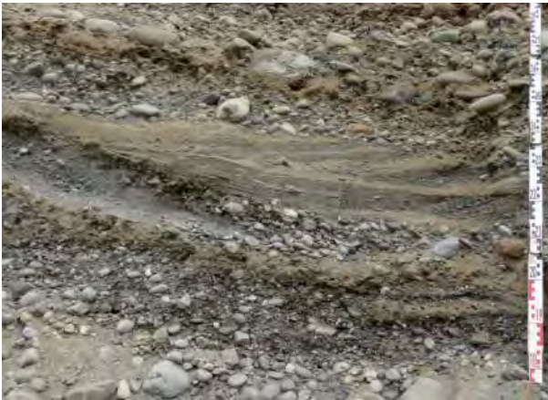
Abb. 78: Kleinräumig schwankende Sandanteile sind für die kiesigen Ablagerungen in Oberschwaben typisch. Aufnahme aus der Kiesgrube Pfullendorf (RG 8021-4).
