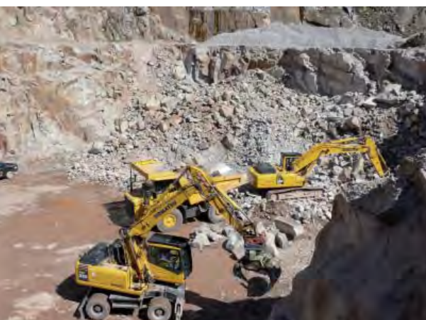
Abb. 96: Gewinnung von Seebach-Granit (RG 7415-1). Der Granit wird überwiegend für den Verkehrswegebau eingesetzt, untergeordnet auch für den Garten- und Landschaftsbau; auch Werksteinblöcke werden wieder nachgefragt.
