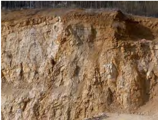
Abb. 91: Die Kalksteine der Hauptrogenstein-Formation eignen sich zur Herstellung von gebrannten Erzeugnissen (Weißfeinkalk, Weißkalkhydrat). Der Abbau wurde im gezeigten Steinbruch Bollschweil (RG 8012-1) im Jahr 2012 eingestellt.
