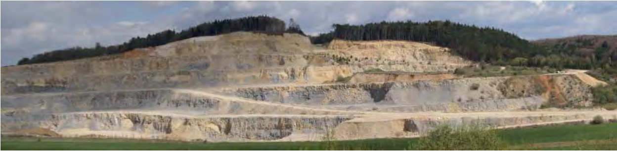
Abb. 104: Abbau von Sedimenten aus dem Oberjura für die Zementherstellung. Gewinnung von Mergelsteinen der Zementmergel-Formation und Kalksteinen der Zementmergel-Formation sowie toniger Sedimente der Unteren Süßwassermolasse im Steinbruch Schelklingen-Vohenbronnen (RG 7624-5). Für die Zementproduktion wird die gesamte Schichtenfolge verwendet.
