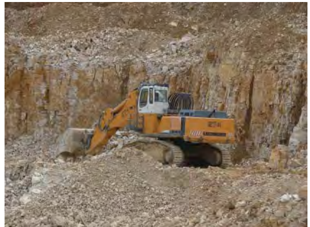
Abb. 103: Abbau von Bankkalkstein aus dem Oberjura als Zuschlagstoff für die Portlandzementherstellung im Steinbruch Heidenheim a. d. Brenz-Mergelstetten (RG 7327-1).
