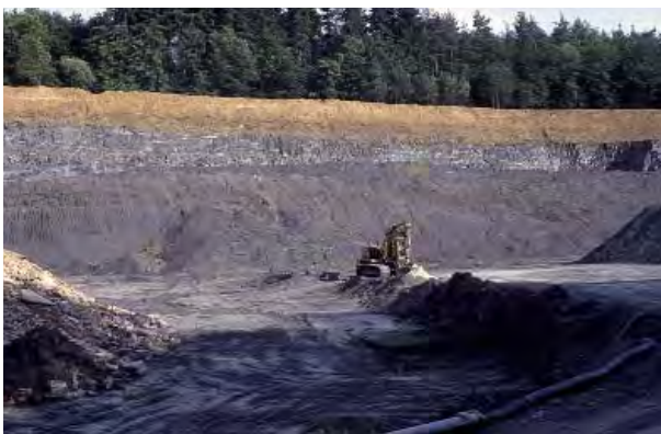
Abb. 153: Im Grenzbereich zur Region Rhein-Neckar werden dunkelgraue Ton- und Schluffsteine zur Herstellung von grobkeramischen Produkten in einer Mächtigkeit von mehreren 10er Metern abgebaut (Aufnahme aus dem Jahr 1991). Der Abbau soll zukünftig in südliche Richtung vorangetrieben werden, weshalb der Regionalverband Mittlerer Oberrhein das LGRB um eine rohstoffgeologische Beurteilung von geplanten Vorrang- und Vorbehaltsgebieten gebeten hatte. Tongrube Mühlhausen-Rettigheim (RG 6718-1).
