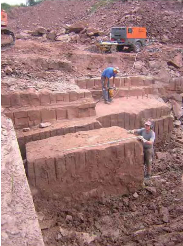
Abb. 112: Die Gewinnung der dickbankigen Lager von rotem Plattensandstein im Steinbruch Seedorf-Vierhäuser (RG 7716-2) bei Schramberg erfolgt – wie auch in den anderen Werksteinbrüchen des Landes – sehr materialschonend: Zunächst wird eine Reihe von Löchern gebohrt, in welche Spaltkeile eingesetzt werden. Der Sandstein wird anschließend mittels eines druckluftbetriebenen Spalthammers in mehrere Kubikmeter große Blöcke gespalten.
