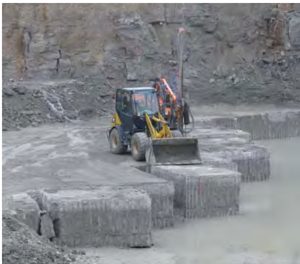
Abb. 113: Im Oberen Muschelkalk wird eine etwa 7 m mächtige Zone für die Werksteingewinnung genutzt. Steinbruch Satteldorf-Neidenfels (RG 6826-3) bei Crailsheim.
