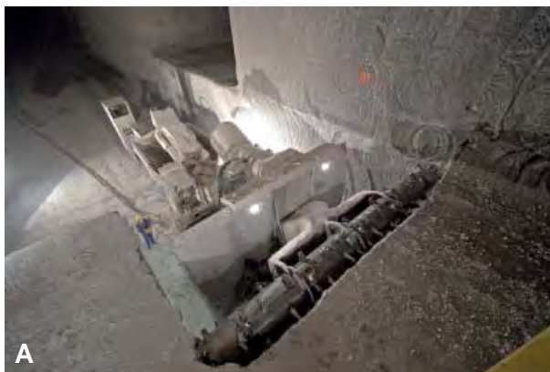
Abb. 125: Untertägige Steinsalzförderung in dem Bergwerk Heilbronn (RG 6821-5) mittels „Continuous Miner“: (A) Schneidende Gewinnung betrachtet von oben und (B) von der Seite.
