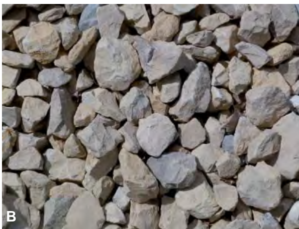
Abb. 92: Gebrochene Kalksteine aus dem Oberjura machen etwa ein Drittel der Kalksteinförderung in Baden-Württemberg aus: (A) Typischer Steinbruch im Oberjura der Schwäbischen Alb, in dem überwiegend gebankte, tonarme Kalksteine gewonnen werden. (B) Die Kalkstein-Schotter. Steinbruch Söhnstetten (RG 7326-1)
