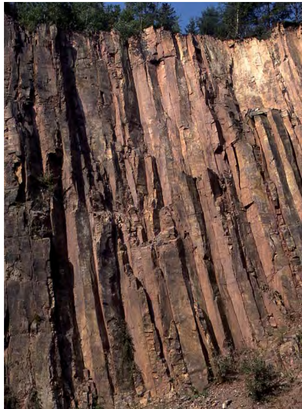
Abb. 98: Brandeck-Quarzporphyr mit der für Abkühlungserscheinungen magmatischer Deckenergüsse charakteristischen Säulenbildung. Quarzporphyr wird hauptsächlich für Straßenbauzwecke abgebaut, kann sich aber auch zur Herstellung von Gleisbettschotter eignen. Aufgelassener Steinbruch Hohberg-Diersburg (Binzenbühl, RG 7613-300).
