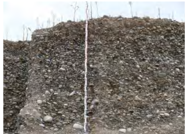
Abb. 155: Typisch grobkörniges bis steinig-blockiges Kieslager im südlichen Oberrheingraben; der Sandanteil liegt nur etwa bei 25 %. Kiesgrube bei Hartheim-Bremgarten (RG 8011-9).
