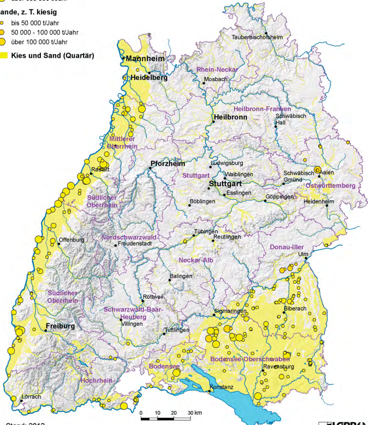
Abb. 77: Übersichtskarte mit Lage der Gewinnungsstellen von Kiesen und Sanden in Baden-Württemberg 2011 mit Angabe von Fördermengenklassen. Nicht dargestellt sind Gruse, die durch Verwitterung entfestigter Granite des Schwarzwalds entstehen, sowie Sande aus verwitterten Mürbsandsteinen. Die Gewinnung von Kiesen und Sanden konzentriert sich auf zwei Schwerpunkte: Oberrheingraben und Alpenvorland.
