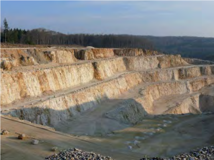
◀ Abb. 175: Die Kalksteinserien im Oberjura der Schwäbischen Alb stellen aus rohstoffgeologischer Sicht die weitaus bedeutendste Einheit in der Region Ostwürttemberg dar. In großen Steinbrüchen werden sie für den Verkehrswegebau, für Baustoffe und Betonzuschlag gewonnen, Kalksteine mit mehr als 99 % Kalkgehalt auch für die Chemische Industrie und die Papierindustrie. Steinbruch bei Waibertal (RG 7227-1, Foto 2011).
