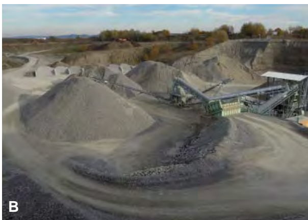
◀ Abb. 166: Trockenabbau von Kies in Oberschwaben: (A) Abbau in Niederterrassenschottern des Rheingletschers bei Leutkirch (RG 8125-2, Foto 2011). (B) Die Aufbereitung – Waschen bzw. Vorsieb und Klassierung – findet üblicherweise direkt bei der Gewinnungsstelle statt; Kiesgrube Bad Waldsee-Mennisweiler (RG 8124-7).
