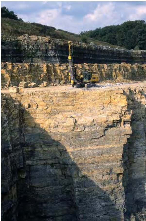
Abb. 90: Typischer Steinbruch im Oberen Muschelkalk. Die Mächtigkeiten des Abraums aus Sedimenten des Unterkreupers nehmen mit dem Fortschreiten des Abbaus vom Talrand in die Hang- oder Kuppenlage in den meisten Fällen zu. Steinbruch Kirchberg an der Murr-Zwingelhausen (RG 7022-1).
