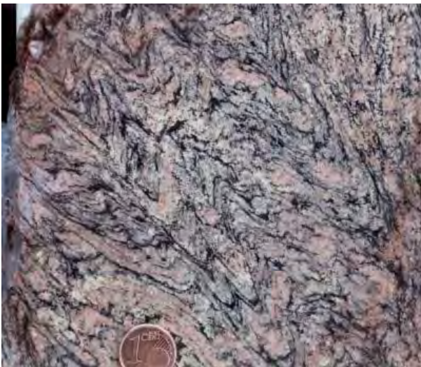
Abb. 95: Eng verfalteter Paragneis aus dem Steinbruch Gengenbach-Schwaibach (RG 7614-3); er wird hauptsächlich zu Brechsanden, Splitten und Schroppen verarbeitet.
