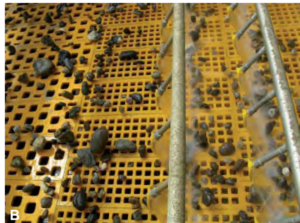
Abb. 84: Kiesgewinnung in der Kiesgrube Singen Hohentwiel-Friedingen (RG 8219-5): (A) Bandanlage. (B) Kieswäsche.
