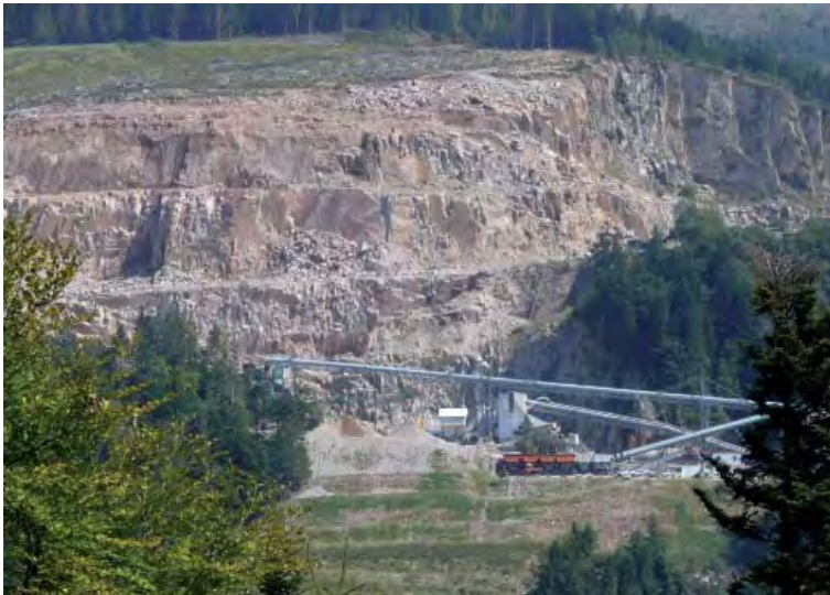
Abb. 158: Blick auf den Granitsteinbruch Seebach (RG 7415-2) mit moderner Anlage zur Erzeugung von Gesteinskörnungen für den qualifizierten Straßenbau (Foto 2008).
