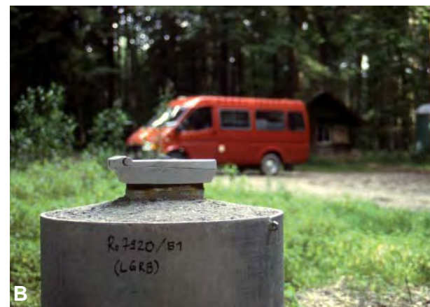
Abb. 17: (A) Kernbohrung zur Erkundung eines Vorkommens hochreiner Kalksteine südlich von Aalen-Ebnat, Kreis Heidenheim. (B) Rohstofferkundungsbohrungen werden häufig zu Pegeln ausgebaut und für die Grundwasserüberwachung genutzt.
