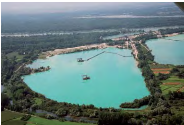
Abb. 22: Aufgrund des hohen Grundwasserstands in diesem großen kies- und sanderfüllten Sedimentbecken (Abb. 21) führt die Kiesgewinnung fast immer zur Anlage von Baggerseen. Der Abbau erfolgt heute mit Schwimmbaggern, die aus Tiefen von 80 m und mehr Kies fördern können.
