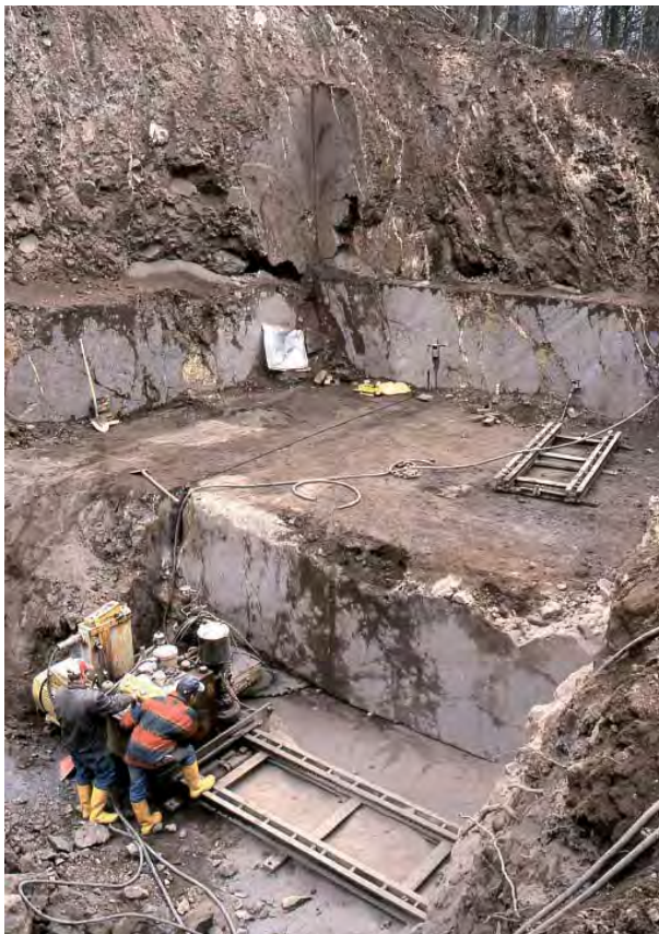
Abb. 33: Arbeiten am Achkarrener Schlossberg zur Gewinnung von Kaiserstühler Tuffstein für das Breisacher Münster, März 2004. Die für die Steinmetzarbeiten benötigten 120 Kubikmeter konnten in wenigen Wochen abgebaut werden.
