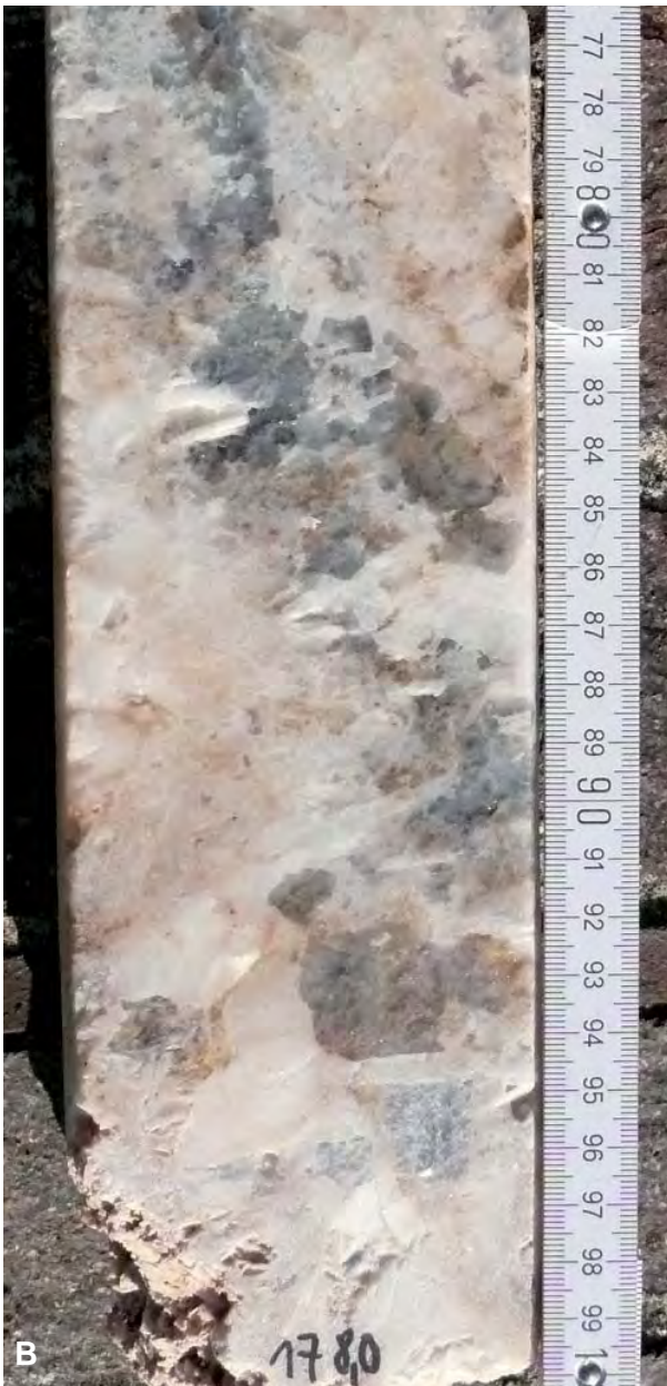
Abb. 52: LGRB-Forschungs- und Erkundungsbohrung Ro7516/B1, Gewinn Hüttenteich, bei Freudenstadt: (A) Bohranlage. (B) Bohrkern aus der Erkundungsbohrung, Abschnitt 177,8–178,0 m. Knapp unterhalb der Oxidationszone, d. h. ca. 30 m unterhalb der mittleren Grundwasseroberfläche (vgl. Abb. 53), wird der Baryt der Gänge zunehmend reiner; außerdem tritt reichlich Fluorit auf (hellgrau bis bläulich).
