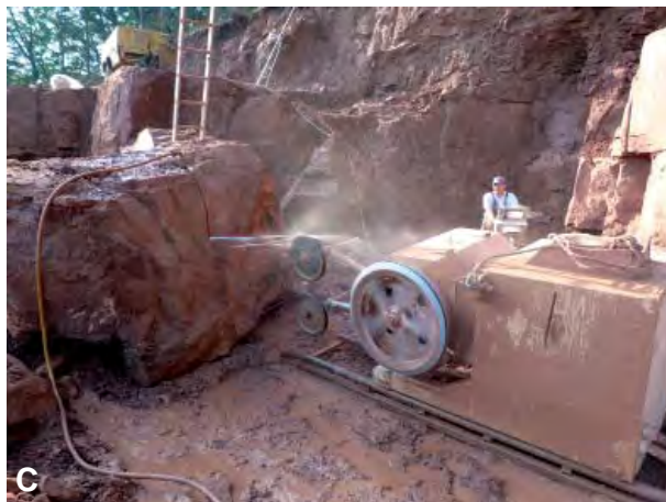
Abb. 47: Neuer „Münstersteinbruch“ bei Tennenbach: (A) Kurz vor Beginn des Probeabbaus im Mai 2012. (B) Gegen Ende des ersten Abschnitts des Probeabbaus im Jahr 2012. (C) Seilsägearbeiten der Fa. Lauster Steinbau.
