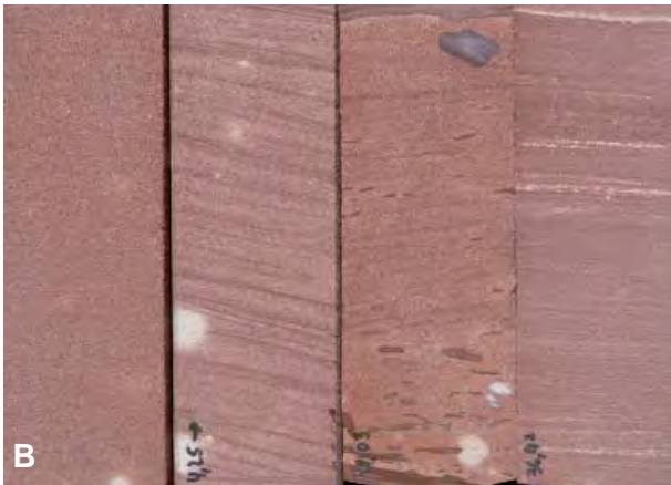
Abb. 45: Erkundungsbohrung am Steinbruch Langauweg bei Tennenbach, nördlich von Freiburg: (A) Aus Erkundungsbohrung und Steinbruchkartierung erstelltes geologisches Profil; gelb dargestellt sind Sandsteine mit Werksteinqualität. (B) Bohrkern aus der Erkundungsbohrung; deutlich wird die Vielfalt der dabei angetroffenen Sandsteintypen. Homogene Typen sind als Bildhauerstein geeignet, solche mit Geröllen aus Quarz oder Tonstein hingegen nicht.
