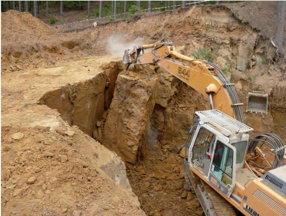
◀ Abb. 39: Probeabbau im Eisensandstein-Vorkommen der Banzenmühle bei Lauchheim, Mai 2011; nach Entfernen der tonigen Abraumschichten wurden Blöcke aus dem weitständig geklüfteten, 5 m mächtigen Eisensandsteinlager gelöst.
