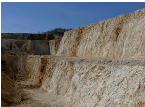
Abb. 54: Die hochreinen Kalksteine der Ostalb bilden ausgedehnte und mächtige Körper; sie werden von 8–12 m dicken, verbräunten Abraumschichten überlagert. Entlang von Klüften und Spalten greifen lokal auch auf Verkarstung zurückzuführende Verbraunungszonen in die Hochreinkalke ein. Die Oberjura-Kalksteine mit einem Kalkgehalt von über 99 % werden derzeit vorwiegend in der chemischen Industrie, Papier-, Pharma-, Bau- und Nahrungsmittelindustrie sowie zur Glasherstellung und Trinkwasserbehandlung verwendet. Blick auf die Nordwand im Stbr. Waibertal (RG 7227-3, Foto 2011); links im Bild die zur Auffüllung des Steinbruchs bereits eingebrachten Abraummassen und Vorsiebungen.
