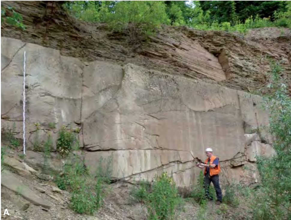
◀ Abb. 15: Rohstoffgeologische Kartierung in Gewinnungsstellen: (A) Bestimmung von Sedimentmächtigkeiten sowie von sedimentologischen und tektonischen Gefügen in einem Sandsteinbruch (RG 6719-1). (B) Aufnahme und Beprobung einer Quarzsandlagerstätte im Goldshöfe-Sand bei Abtsgemünd (RG 7025-3), Ostalbkreis. Die Lage eines Probenahmepunkts wird mittels GPS genau lokalisiert, wodurch Analysedaten auch mit kartographischen Daten verknüpft werden können.
