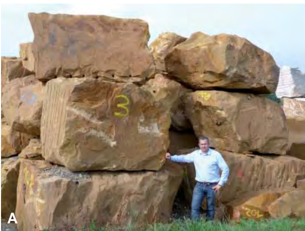
Abb. 40: Rohblöcke aus Lauchheimer Eisensandstein: (A) Blocklager im Werk der Bamberger Natursteinwerke Hermann Graser; dort erfolgte zunächst die Probenahme für die gesteintechnischen Untersuchungen, dann die Vorfertigung der Blöcke für die Münsterbauhütte Ulm. (B) In der Münsterbauhütte Ulm im Jahr 2012 erstellte Werkstücke aus Lauchheimer Eisensandstein kurz vor dem Einbau am Chorbau des Ulmer Münsters.
