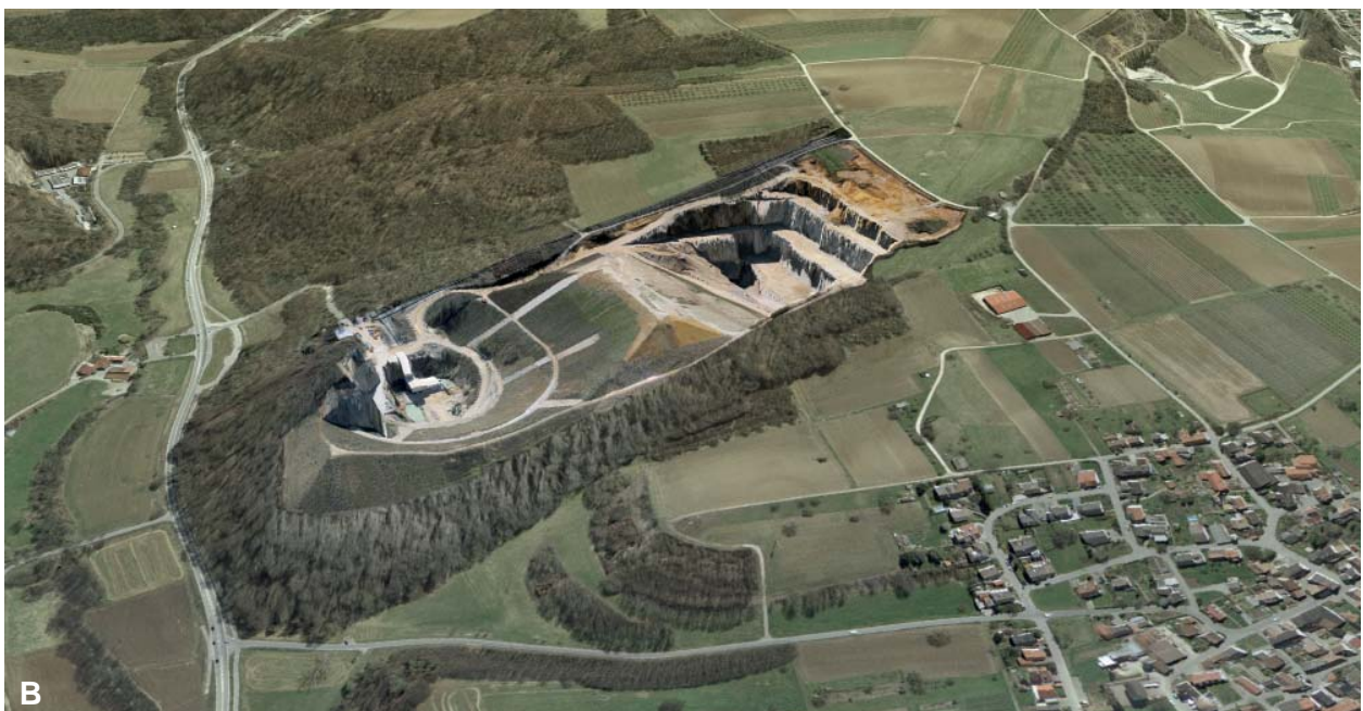
Abb. 1: Beispiele für Rohstoffgewinnungsstellen: (A) Steinbruch und Kalkwerk bei Istein am südlichen Oberrhein (Region Hochrhein-Bodensee), daneben alte, renaturierte Steinbruchbereiche und natürliche Steilkanten (Aufnahme im Jahr 2000). (B) Zum Kalkwerk Istein gehöriger Steinbruch Kapf bei Huttingen mit Abbaugelände und aufgefülltem Bereich (links, mit Wasserhaltung); rechts oben: Betriebsgelände Istein (s. Abb. 1 A).
