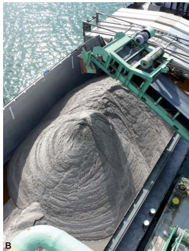
Abb. 2: Aufgehaldete Rohstoffe, fertig zum Transport: (A) Produkthalde in einem Sandwerk; Aufhaldungen dieser Art dienen der Steuerung der Produktion. Ein Förderband (links) liefert den gewaschenen Sand an, ein unterirdischer Bandabzug transportiert den Sand zur Weiterverarbeitung. (B) Verladung des Rohproduktes Sand auf ein Rheinschiff in unmittelbarer Nähe der Gewinnungsstelle zum Weitertransport in ein Betonwerk.
