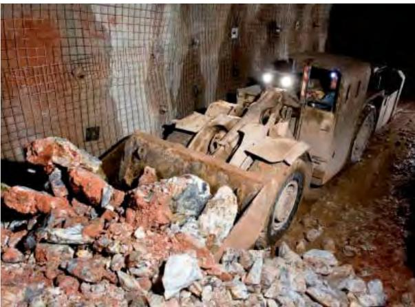
Abb. 134: Laden im Streckenvortrieb.
