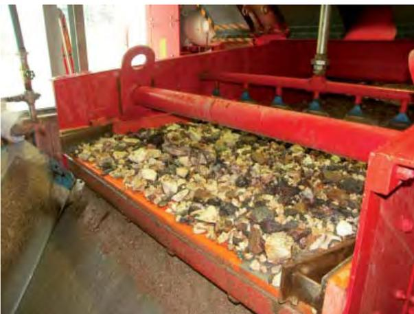
Abb. 135: Aufbereitung in Wolfach: Zu den ersten Schritten gehören Zerkleinern, Reinigen und Sortieren des angelieferten Förderguts.
