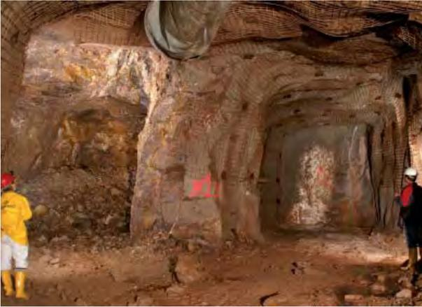
Abb. 133: Streckenvortrieb auf zwei parallelen Gangstrukturen in der Grube Clara, Diagonaltrum auf der Sohle 8.3.
