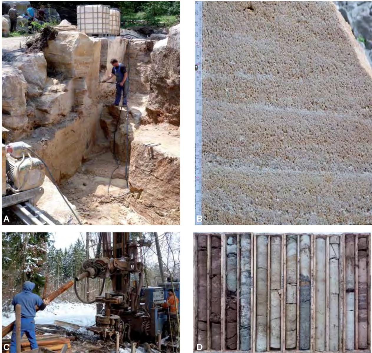
**Abb. 41:** Erkundung auf Stubensandstein für das Ulmer Münster: (A) Probeabbau bei Waldenbuch, 2012. (B) Problock aus kieselig gebundenem Stubensandstein vor der gesteinsphysikalischen Analyse. (C) Zweiter Teil der Erkundung durch Kernbohrungen bei Waldenbuch im Februar 2013 (Bohrung Ro7320/B12). (D) Gekerkte Schichtenabfolge im Stubensandstein mit raschen Fazies- und Farbwechseln, Rohstofferkundungsbohrung Ro7320/B7.
