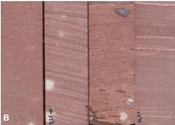
**Abb. 45:** Erkundungsbohrung am Steinbruch Langauweg bei Tennenbach, nördlich von Freiburg: (A) Aus Erkundungsbohrung und Steinbruchkartierung erstelltes geologisches Profil; gelb dargestellt sind Sandsteine mit Werksteinqualität. (B) Bohrkern aus der Erkundungsbohrung; deutlich wird die Vielfalt der dabei angetroffenen Sandsteintypen. Homogene Typen sind als Bildhauerstein geeignet, solche mit Geröllen aus Quarz oder Tonstein hingegen nicht.
