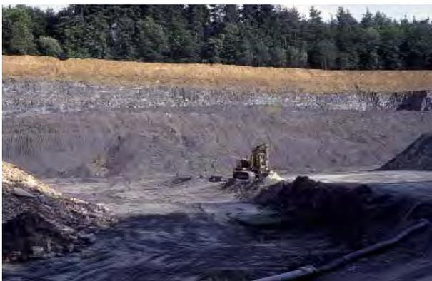
Abb. 153: Im Grenzbereich zur Region Rhein-Neckar werden dunkelgraue Ton- und Schluffsteine zur Herstellung von grobkeramischen Produkten in einer Mächtigkeit von mehreren 10er Metern abgebaut (Aufnahme aus dem Jahr 1991). Der Abbau soll zukünftig in südliche Richtung vorangetrieben werden, weshalb der Regionalverband Mittlerer Oberrhein das LGRB um eine rohstoffgeologische Beurteilung von geplanten Vorrang- und Vorbehaltsgebieten gebeten hatte. Tongrube Mühlhausen-Rettigheim (RG 6718-1).
