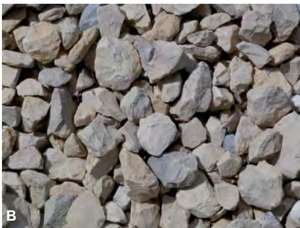
**Abb. 92:** Gebrochene Kalksteine aus dem Oberjura machen etwa ein Drittel der Kalksteinförderung in Baden-Württemberg aus: (A) Typischer Steinbruch im Oberjura der Schwäbischen Alb, in dem überwiegend gebankte, tonarme Kalksteine gewonnen werden. (B) Die Kalkstein-Schotter. Steinbruch Söhnstetten (RG 7326-1)
