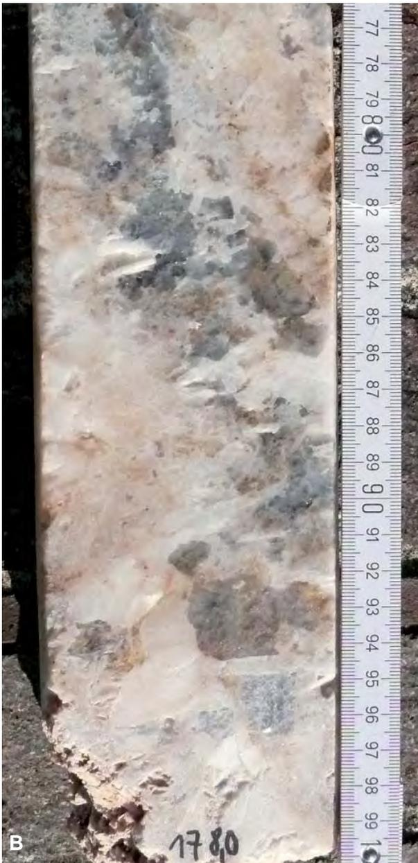
**Abb. 52:** LGRB-Forschungs- und Erkundungsbohrung Ro7516/B1, Gewinn Hüttenteich, bei Freudenstadt: (A) Bohranlage. (B) Bohrkern aus der Erkundungsbohrung, Abschnitt 177,8–178,0 m. Knapp unterhalb der Oxidationszone, d. h. ca. 30 m unterhalb der mittleren Grundwasseroberfläche (vgl. Abb. 53), wird der Baryt der Gänge zunehmend reiner; außerdem tritt reichlich Fluorit auf (hellgrau bis bläulich).
