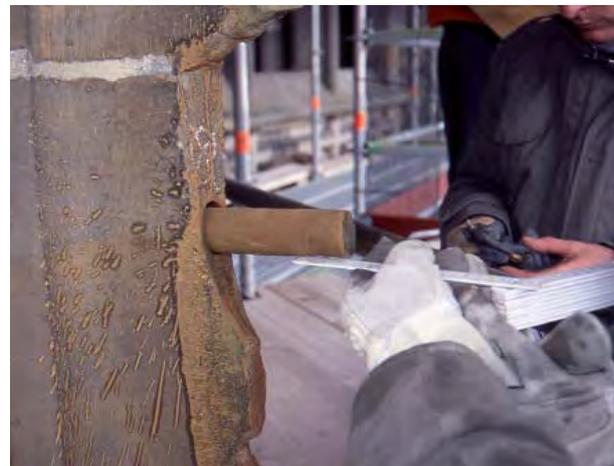
**Abb. 36:** Probeentnahme am Ulmer Münster zum petrographischen und geochemischen Vergleich geschädigter und intakter Eisensandsteine aus der mittelalterlichen Bauphase.
