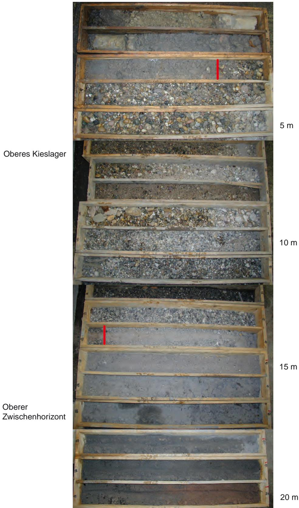
Abb. 3.1: Fotodokumentation der Bohrung KA 39-6a mit lithostratigrafischer Gliederung
