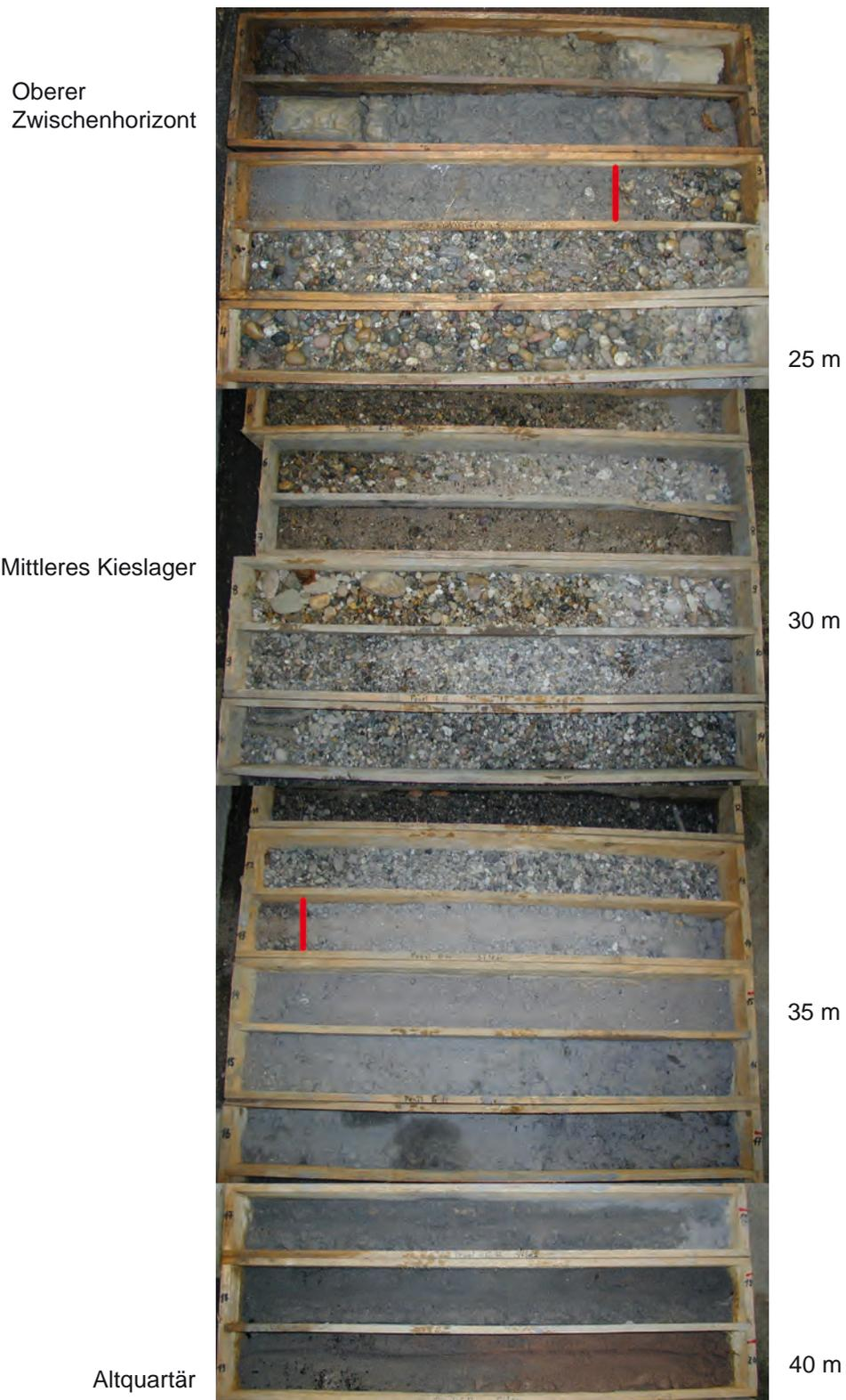
Abb. 3.2: Fotodokumentation der Bohrung KA 39-6a mit lithostratigrafischer Gliederung
