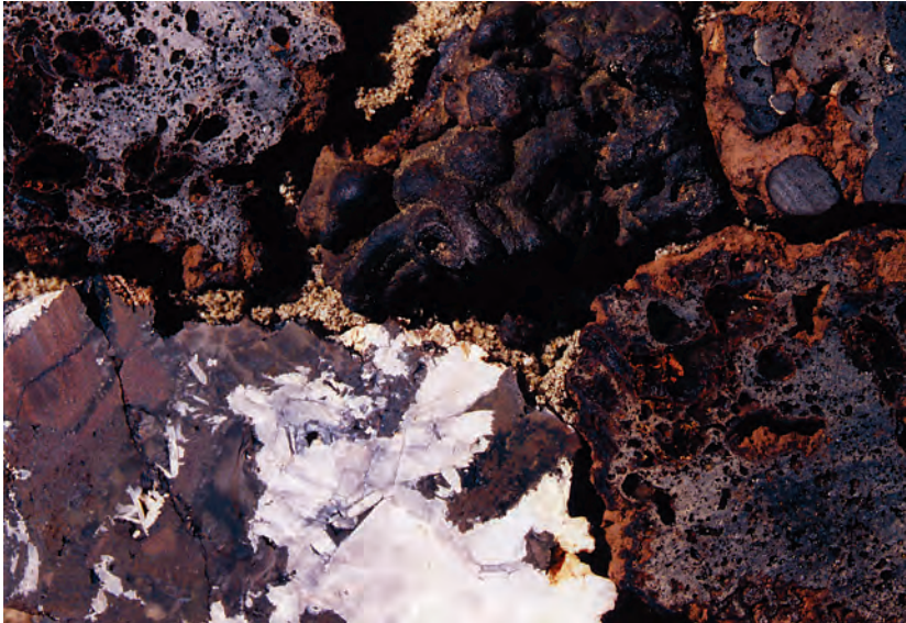
◀ Abb. 72 Schlacken der 2600 Jahre alten Eisenerzverhüttung bei Neuenbürg.
