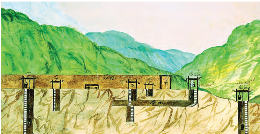
◀ Abb. 83 Beispiel eines markscheiderischen Seigerisses aus dem 18. Jahrhundert.
